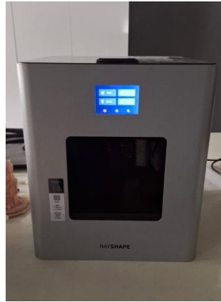
Şekil 3.10. Son polimerizasyon işleminin yapıldığı cihaz (Rayshape, Desktop Photocurable 3D printer).
