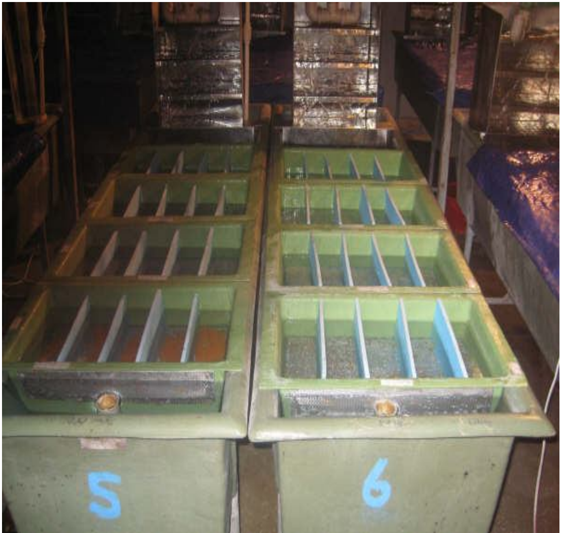
Şekil 2.2. Su sistemine bağlı 310 l'lik fiberglas tanklar
