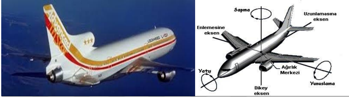
Şekil 11. Bir L-1011 hava taşıtı ve hareket eksenleri
