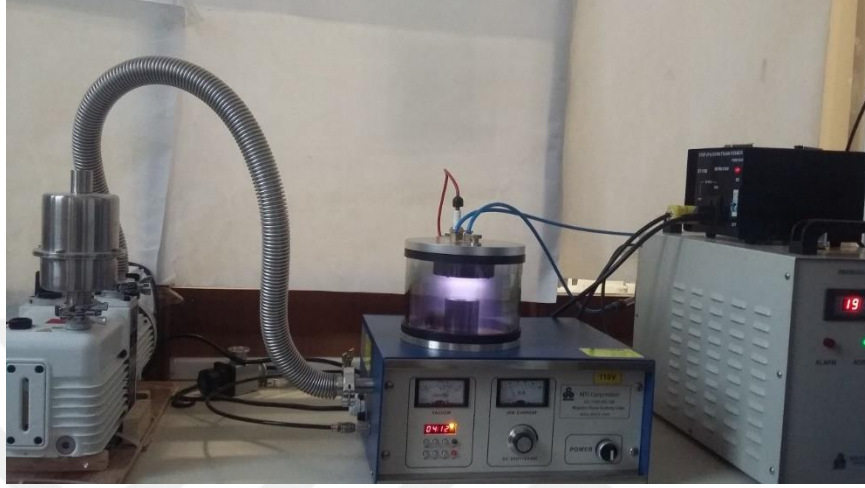
Şekil 3.4. Kaplamalar için kullanılan saçtırma sistemi
