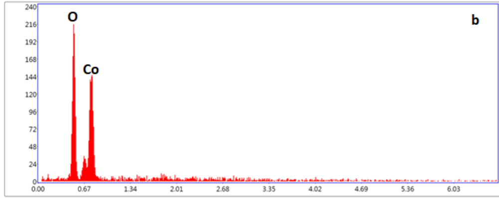
Şekil 4.13. Co-Co 3 O 4 katalizörüne ait a) SEM görüntüsü b) EDS sonucu
