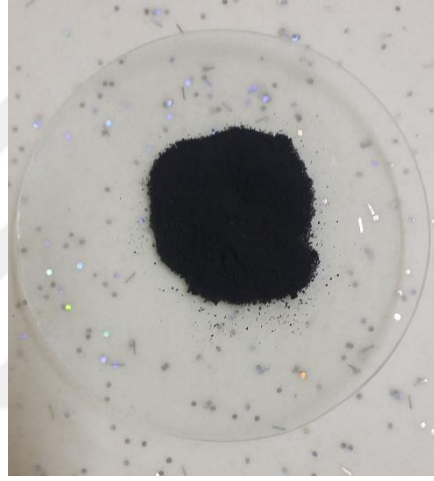
Şekil 3.1. Toz halde elde edilen \text{Co}_3\text{O}_4 destek malzemesi
