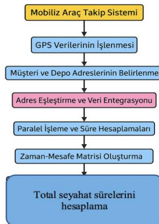
Şekil 87. Diğer algoritmalar için pivot özelliği taşıyan GPS-tabanlı zaman mesafe matrisi
