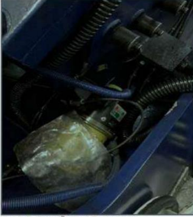
Şekil 1. Gres Ünitesi Demontajı
