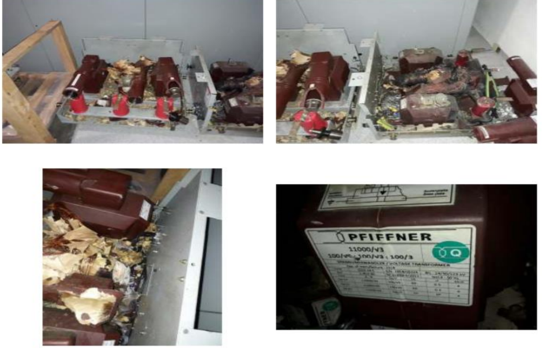
Şekil 3.15. Jeotermal Enerji Santralinde Hasarlı Trafo Parçaları
