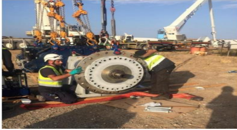
Şekil 3.1. Rüzgâr Enerji Santralinde Hasarlı Şaft
