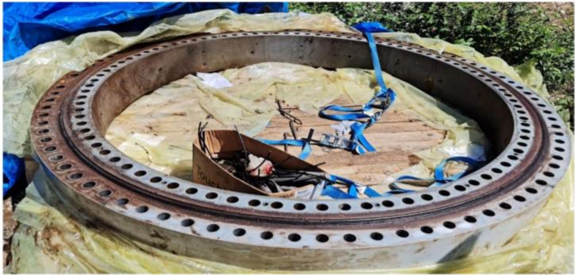
Şekil 3.2. Rüzgâr Enerji Santralinde Hasarlı Kanat Yatağı
