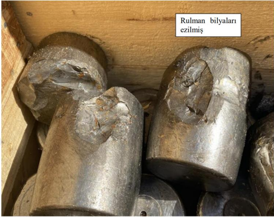
Şekil 3.5. Rüzgâr Enerji Santralinde Ezilmiş Rulman Bilyeleri
