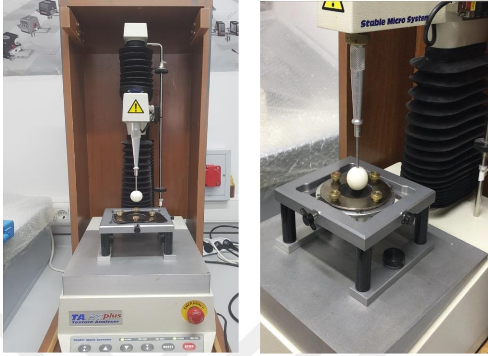
Şekil 11. Pestil örneklerinde yapılan gerilim-gevşeme testi
