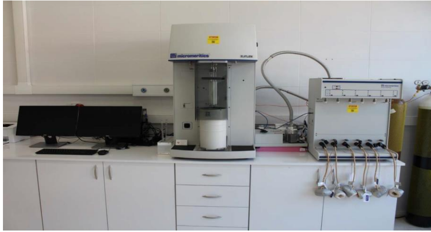
Şekil 14. BET yüzey alanı ölçüm cihazı (DAYTAM)
