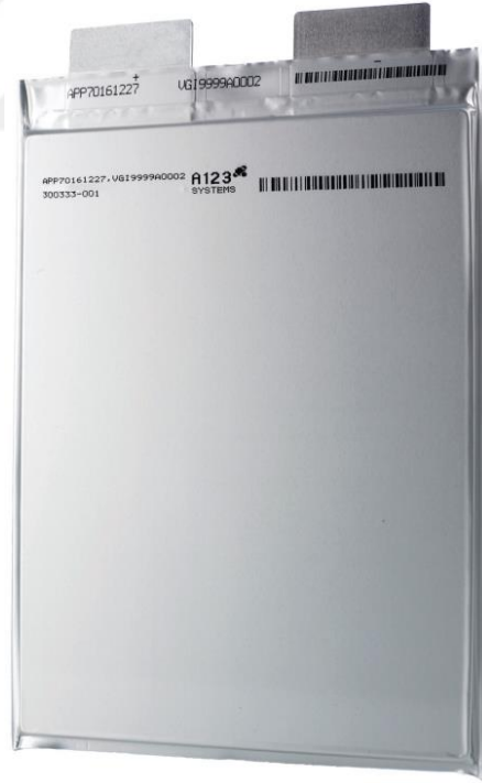
Şekil 24. Soğutma deneylerinde kullanılan torba tip batarya
