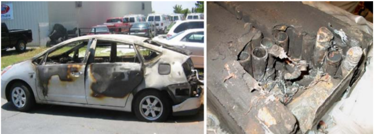
Şekil 6. Isıl sürüklenme ile bataryası alev alan bir elektrikli araç (Wu et al. 2019)
