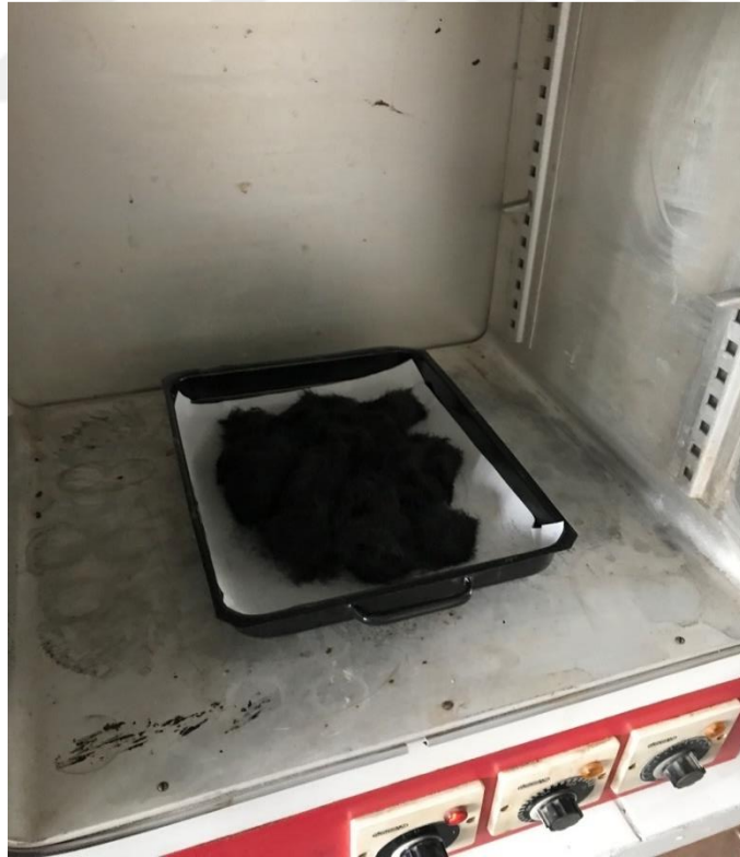
Şekil 3.3. 80°C'de etüvde kurutulan yıkanmış saçlar
