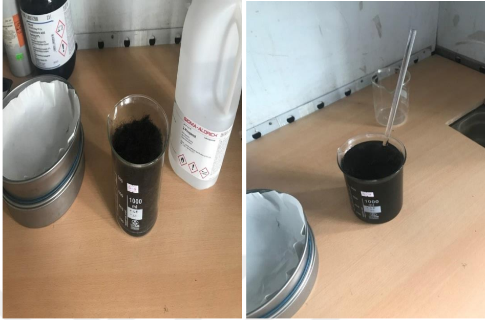
Şekil 3.2. 2-propanol ile yıkanan saçlar
