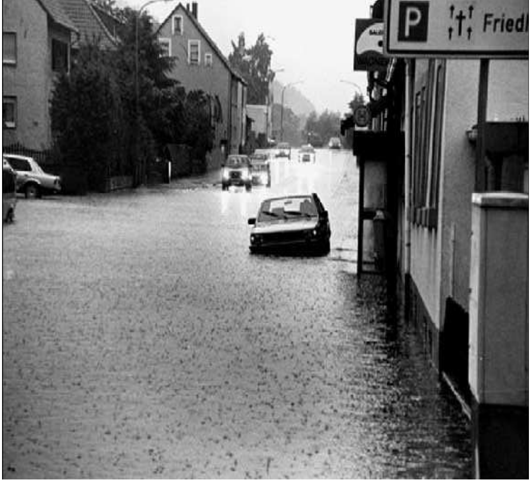
Şekil 1.11. Yağmursuyu drenajının yetersiz kaldığı veya olmadığı bir cadde
