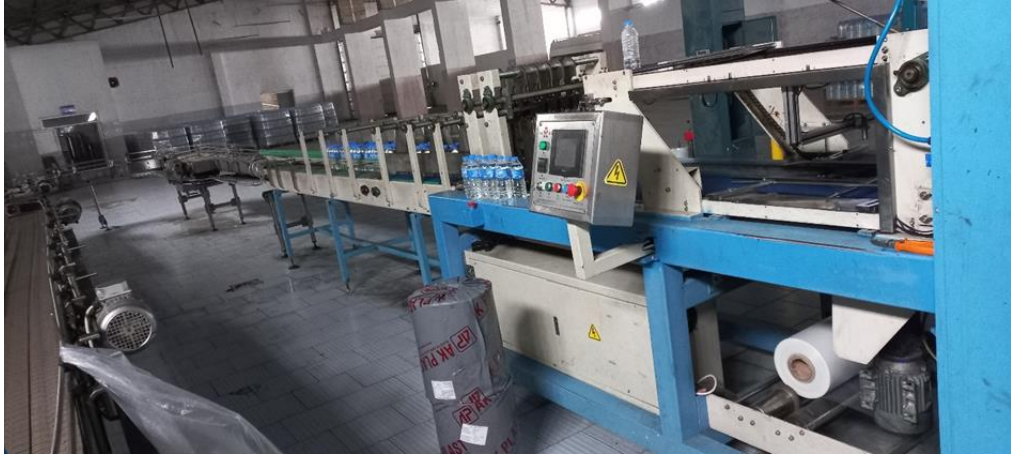
Şekil 21. Şişelerin Paketleme Makinesine Girişi
