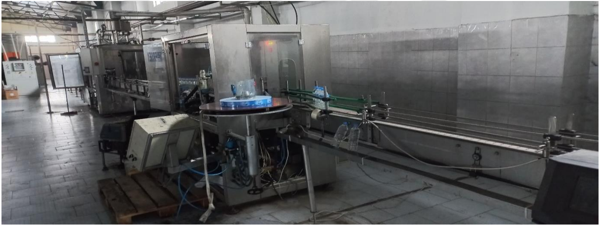
Şekil 20. Şişeleri Etiketleme Makinesi Çıkış Bölümü
