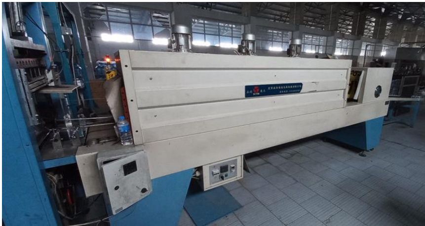
Şekil 23. Paketlenmiş Suların Isı Verilerek Kaplandığı Fırın
