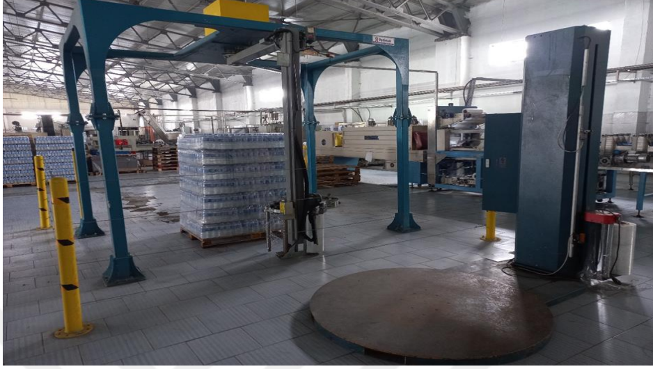
Őekil 24. Paketlenmiř ve Paletlenmiř Suların Stre le Sarıldığı Makine
