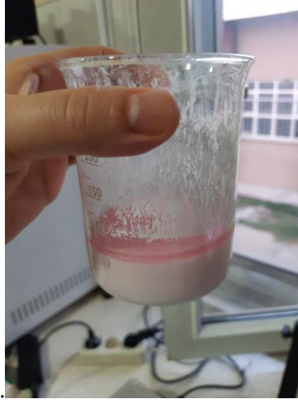
Şekil 17. \text{Co}_3\text{O}_4@\text{Bi}_2\text{O}_3 kaplama çözeltisi
