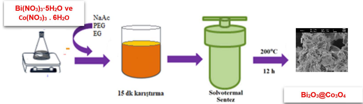
Şekil 16. \text{Co}_3\text{O}_4@\text{Bi}_2\text{O}_3 sentezinin şematik gösterimi
