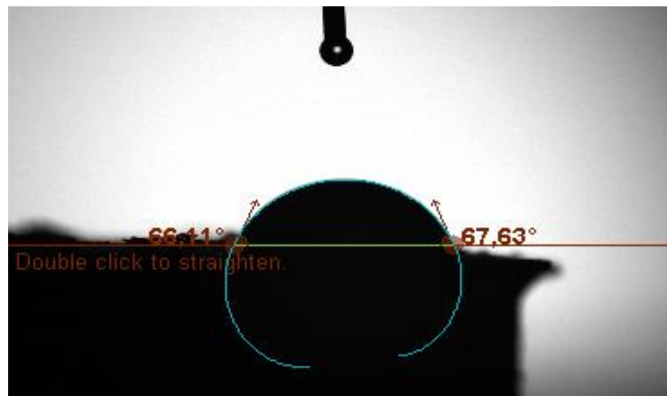
Şekil 4.17. Adsorbsiyon sonrası Aktive ŞPK'ın temas açısı (66.37°)
