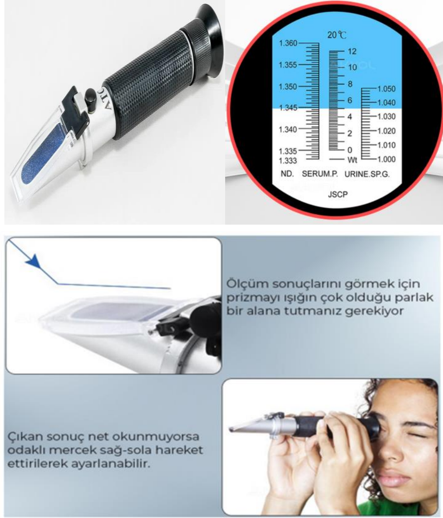
Şekil 3.1. Refraktometre cihazı ve kullanım şekli
