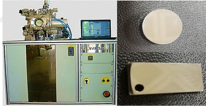
Şekil 3.4. PVD Kaplama cihazı (Püskürtme Yöntemi), numunelerin PVD kaplama işleminden sonraki görüntüsü
