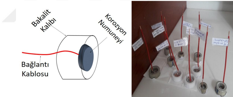
Şekil 3.9. Korozyon numuneyi örneği ve gerçek korozyon numunelerin
