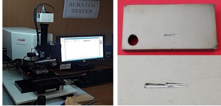
Şekil 3.5. Testlerde kullanılan çizik test makinasının bir resmi ve test sonrası numune yüzeyinin örnek görüntüsü
