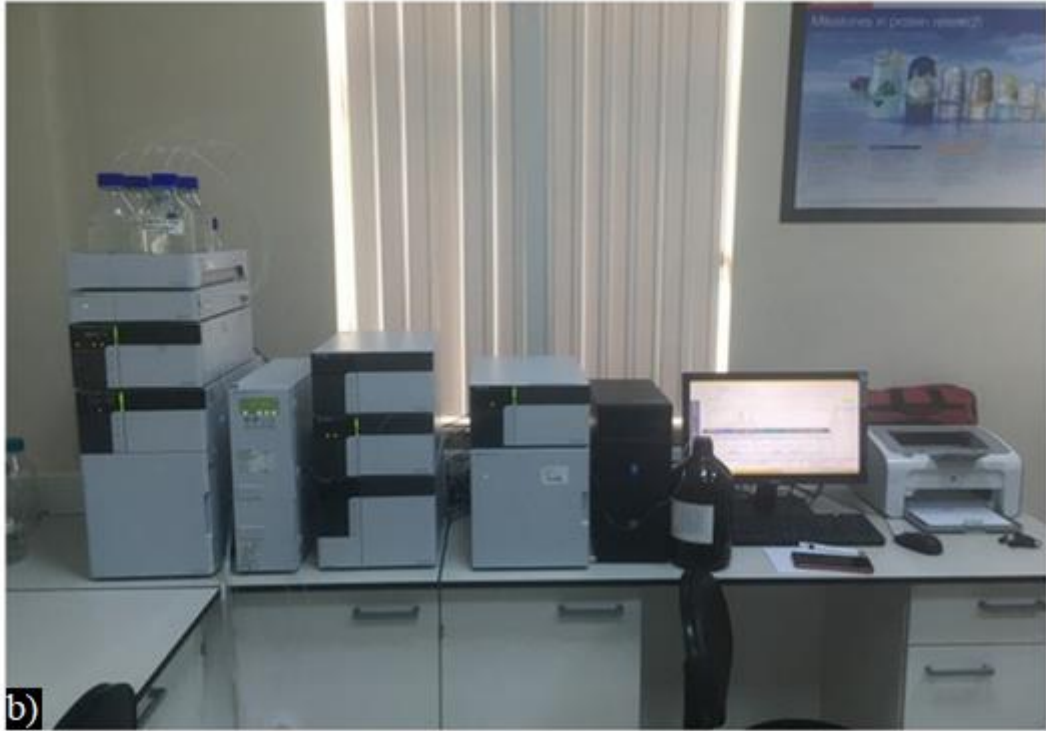
Şekil 20. Trigonelline ve diosgenin analizinde kullanılan a) GC-MS ve b) HPLC cihazları
