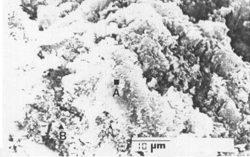
Şekil 2.26. Düşük s/ç silis dumanlı betonda yoğun hidrate çimento hamuru, A=C-S-H, B=CH'in küçük kristalleri
