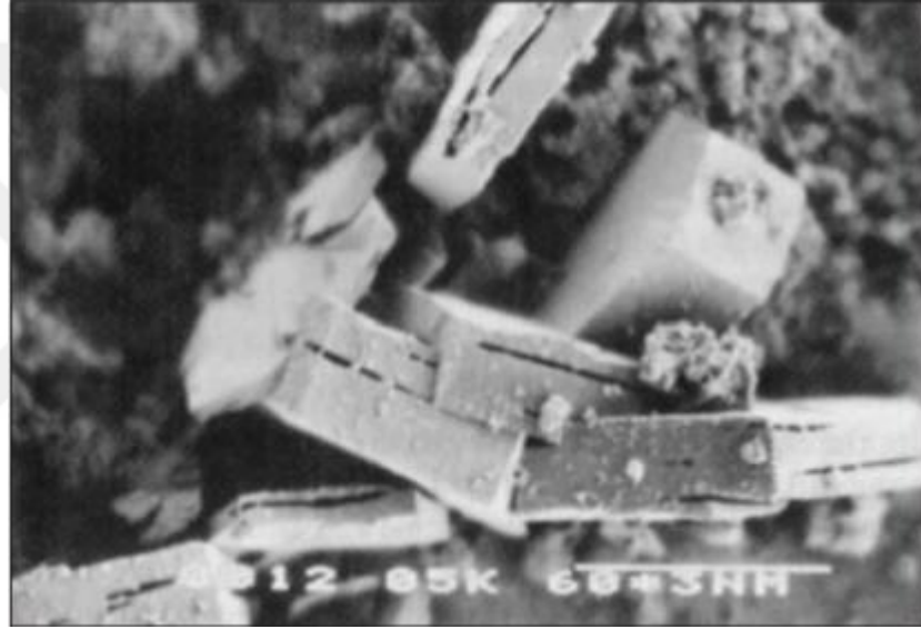
Şekil 2.17. Beton arayüzey geçiş bölgesi (a) SEM görüntüsü
