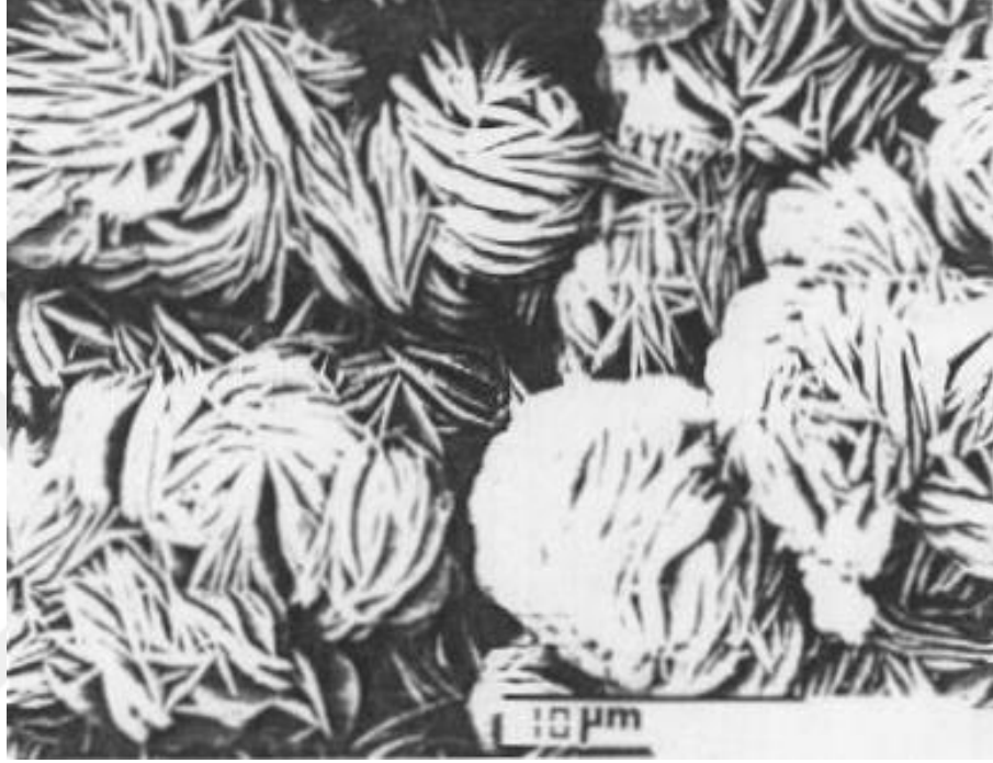
Şekil 2.38. Alkali-agrega reaksiyonu kristalinin yapısının görünümü
