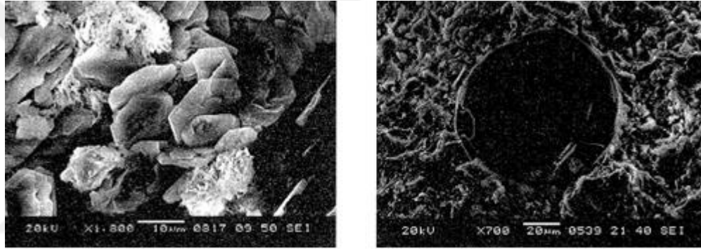
Şekil 2.13. Hegzagonal kalsiyum hidroksit kristalleri
