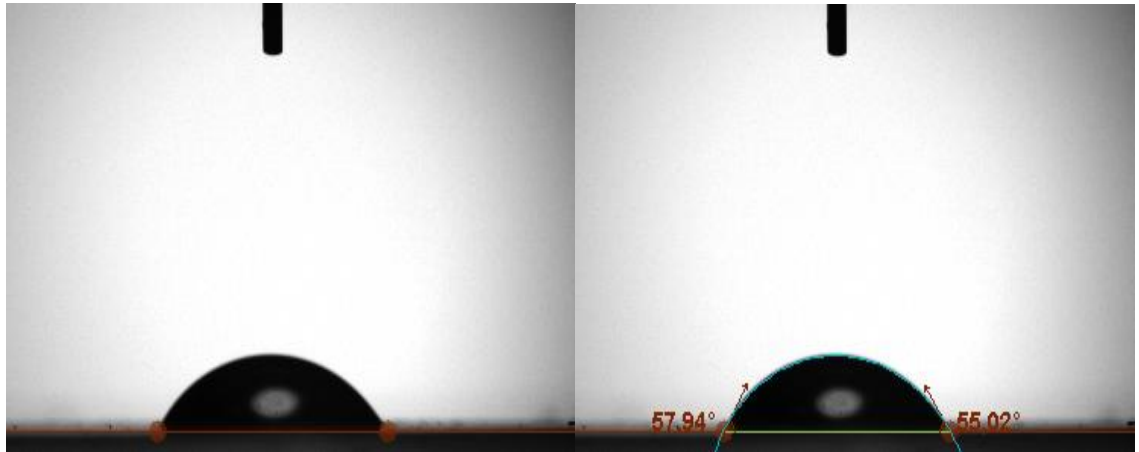
Şekil 4.4. Pd katkılı NiO (p tipi) yarıiletkenine ait yüzey temas açısı ölçümü
