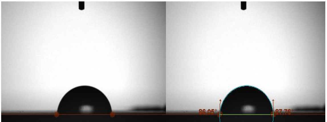
Şekil 4.17. InP (Un) n tipi III-V yarıiletkenine yüzey temas açısı ölçümü
