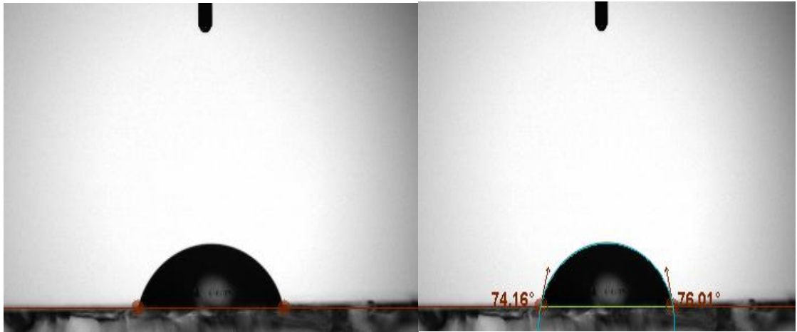
Şekil 4.14. \text{TiO}_2 (n tipi) yarıiletkenine ait yüzey temas açısı ölçümü
