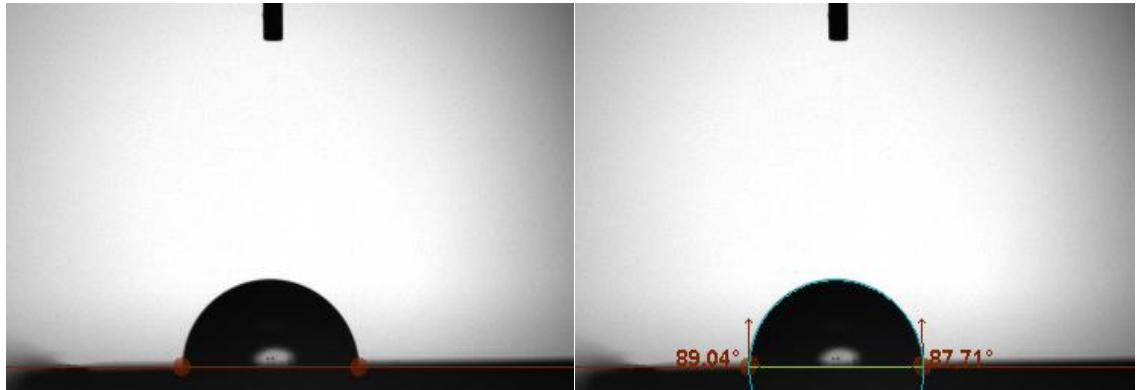
Şekil 4.7. SI/GaAs (Un) III-V yarıiletkenine ait yüzey temas açısı ölçümü
