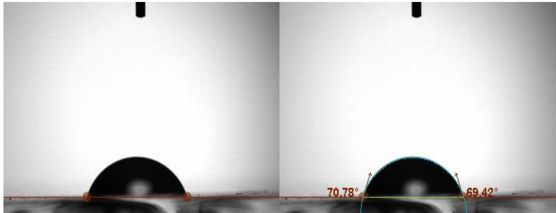
Şekil 4.13. Pd katkılı NiO (p tipi) yarıiletkenine ait yüzey temas açısı ölçümü
