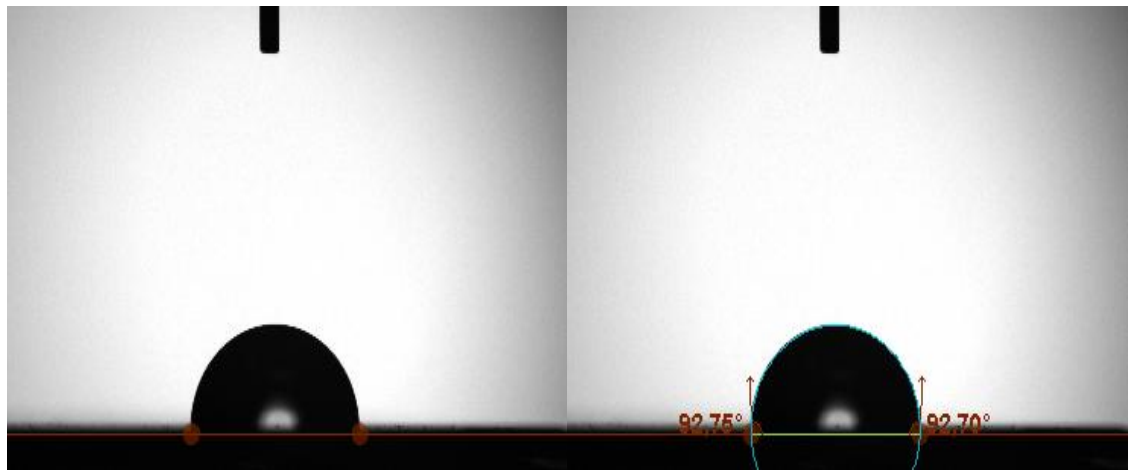
Şekil 4.9. SI/InP (Fe) III-V yarıiletkenine ait yüzey temas açısı ölçümü
