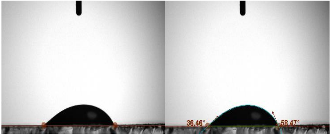
Şekil 4.5. \text{TiO}_2 (n tipi) yarıiletkenine ait yüzey temas açısı ölçümü
