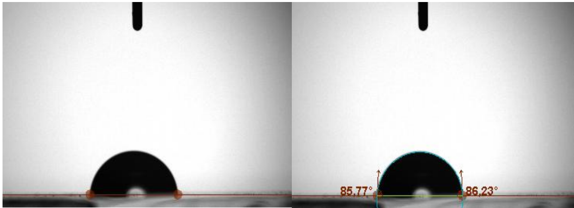
Şekil 4.3. NiO (p tipi) yarıiletkenine ait yüzey temas açısı ölçümü
