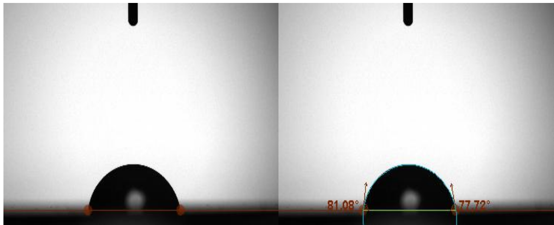
Şekil 4.8. InP (Un) n tipi III-V yarıiletkenine ait yüzey temas açısı ölçümü
