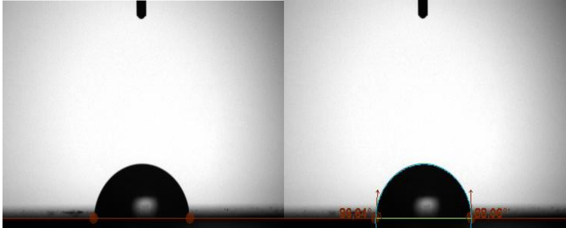
Şekil 4.15. GaAs (Te) n tipi III-V yarıiletkenine ait yüzey temas açısı ölçümü
