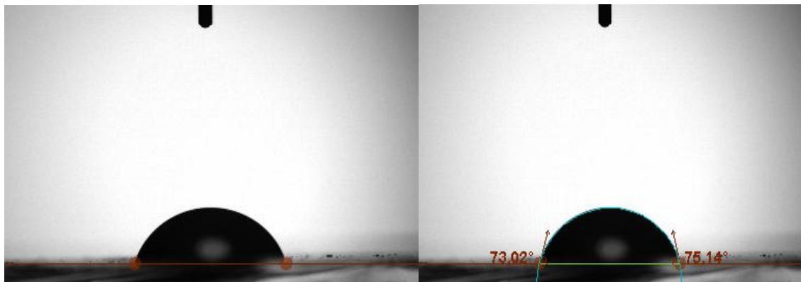
Şekil 4.10. WO 3 (n tipi) yarıiletkenine ait yüzey temas açısı ölçümü
