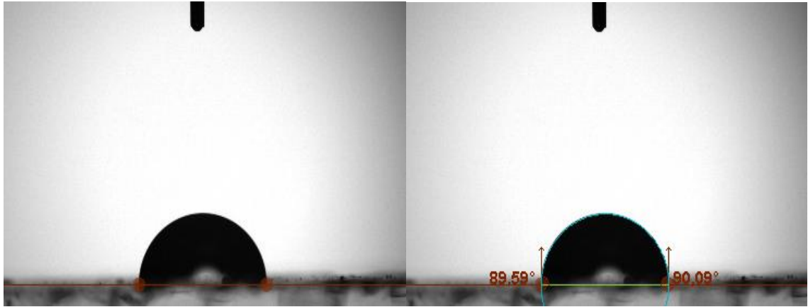
Şekil 4.11. Pd katkılı WO 3 (n tipi) yarıiletkenine ait yüzey temas açısı ölçümü
