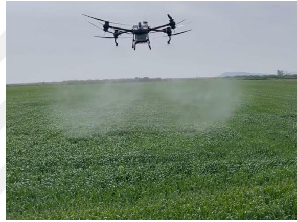
Şekil 5. DJI Agras T40 pestisit hazırlama ve püskürtme (Orijinal)
