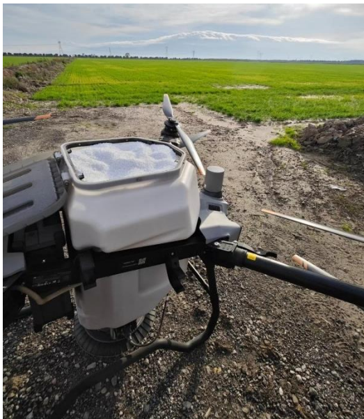
Şekil 6. DJI Agras T40 katı gübre tankı ve gübre yayma (Orijinal)
