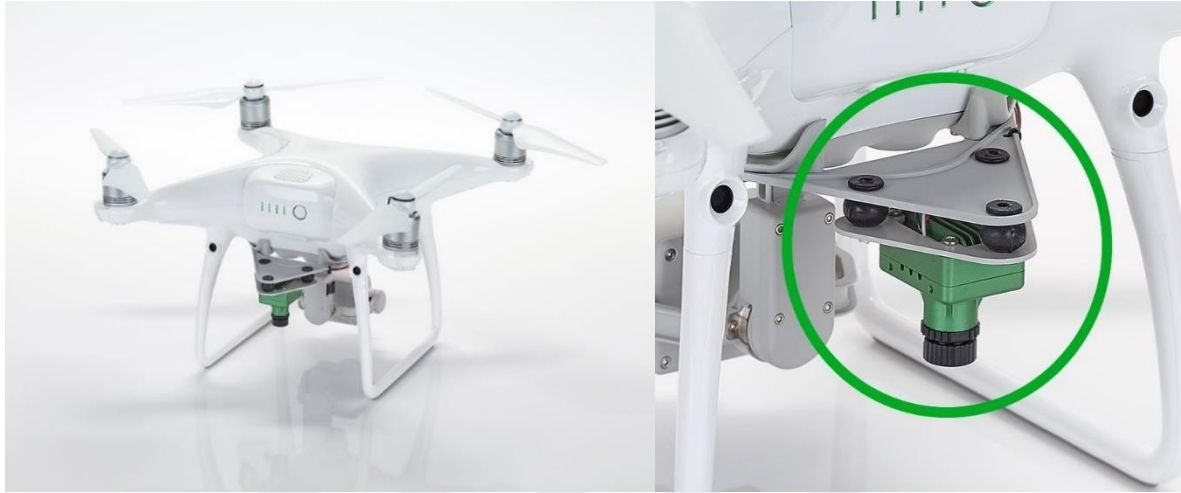
Şekil 3. Sentera DJI Phantom 4 Pro V2.0 NDVI sensör entegrasyonu (DJI 2024a)
