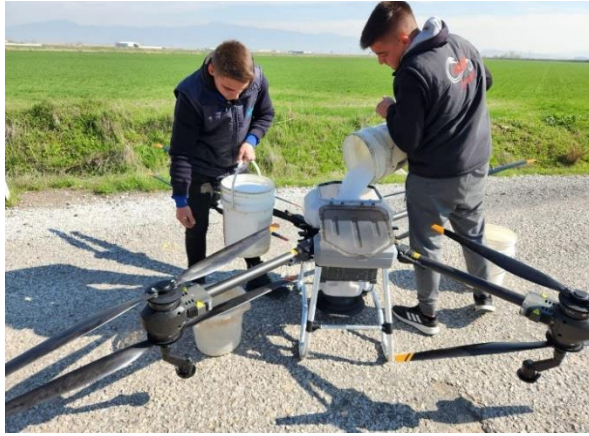
Şekil 5. DJI Agras T40 pestisit hazırlama ve püskürtme (Orijinal)
