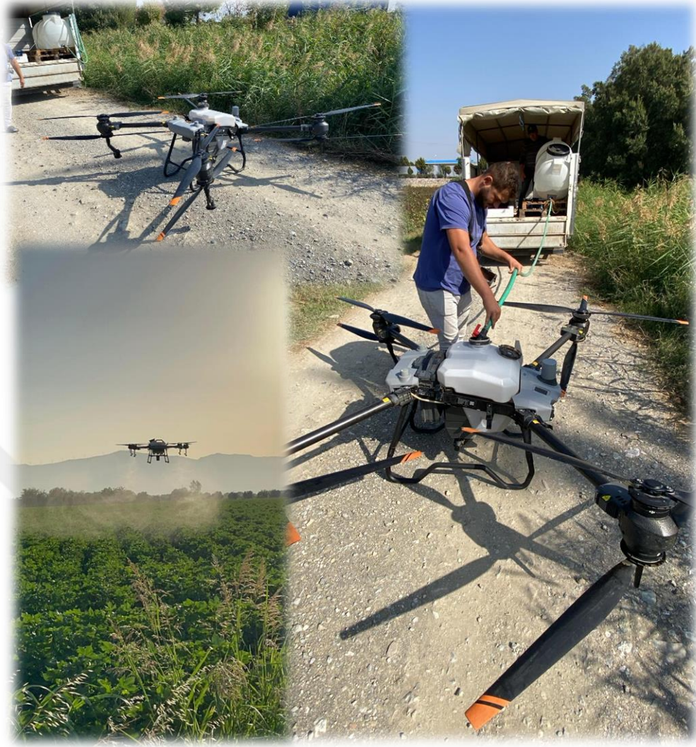
Şekil 41. DJI Agras T40 ilaçlama uygulaması ve ilaçlama öncesi hazırlık (Orijinal)
