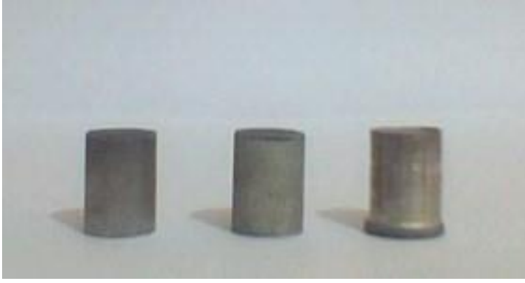
Şekil 3.4. Sinterlenmiş Numunelerin Fotoğrafları (soldaki 200 MPa, ortadaki 400 MPa ve sağdaki 600 MPa basınç ile preslenmiş peletler)
