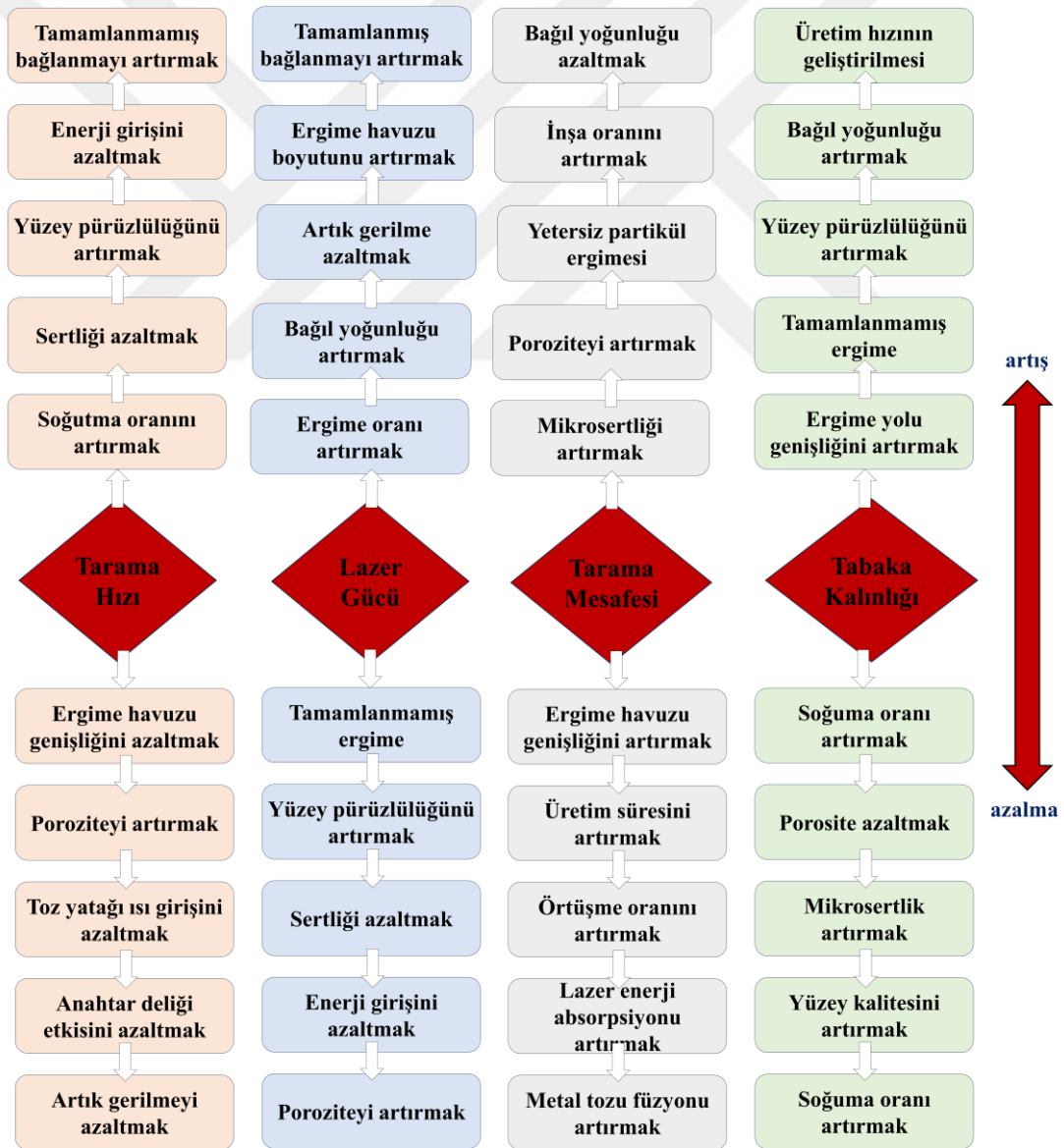
Şekil 10. SLM ile üretilen malzemelerde üretim parametreleri ve malzeme üzerindeki etkileri (Sefene, 2022)
