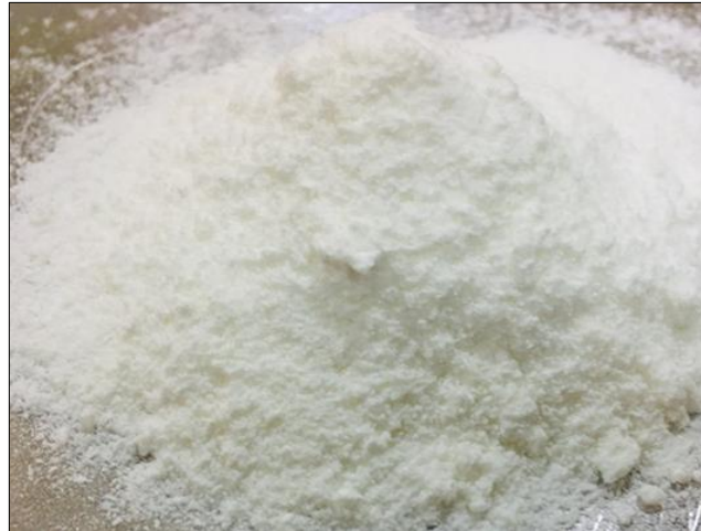
Şekil 48. Çimento kompozitlerinin üretimi sırasında kullanılan SDS sürfaktan malzeme.
