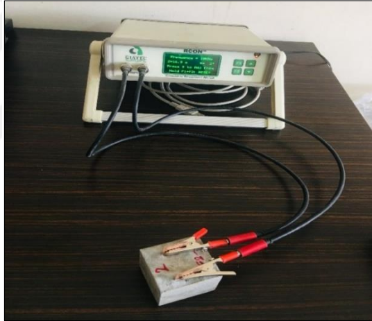
Şekil 75. Kompozitlerin elektrik direnç ölçümleri (Giatec RCON2).
