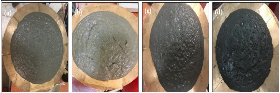
Şekil 70. Yayılma tablası testleri (a) çimento hamuru (b) KF (c) NNi (d) KNT.
