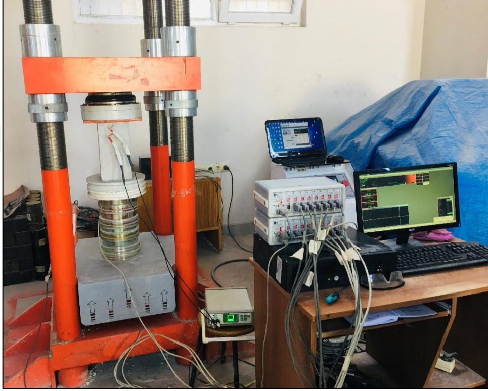
Şekil 82. Akıllı beton elemanın periyodik ve monotonik basınç yüklemesi altında deneysel testi.
