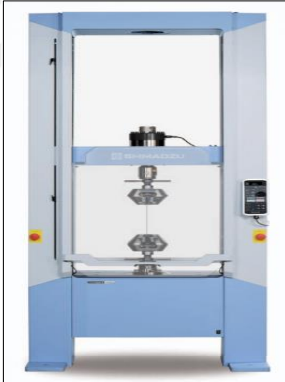
Şekil 60. Periyodik yükleme testi için test presi.
