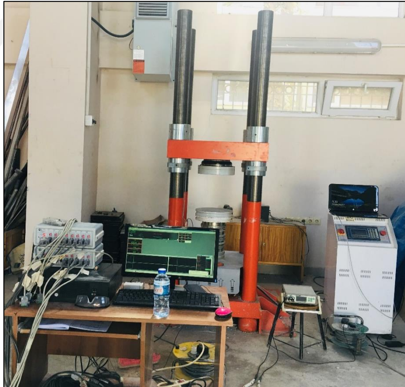
Şekil 62. Monotonik ve periyodik yükleme testi için 3000 kN kapasiteli pres aleti.
