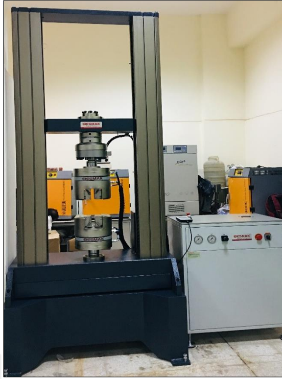
Şekil 61. Periyodik yükleme testi için 300 kN test presi.
