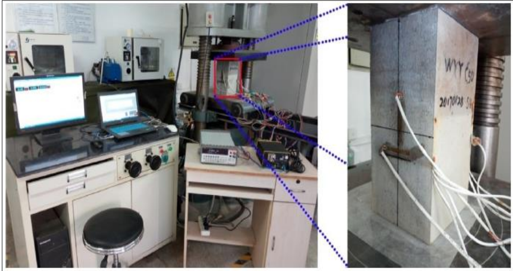
Şekil 40. Kendiliğinden algılama özellikli kolon test düzeneği (Ding et al. 2019).
