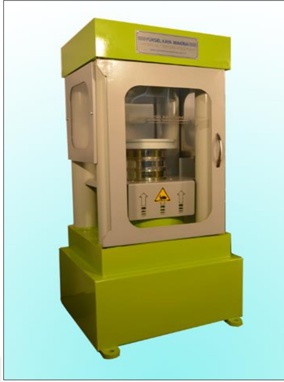
Şekil 59. Monotonik yükleme testi için pres aleti.
