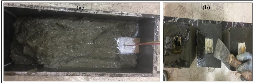
Şekil 73. Akıllı beton elemanın döküm işlemi (a) sensörlerin elemana gömülmesi, (b) eleman üst yüzeyinin epoksi reçine ile kaplanması.
