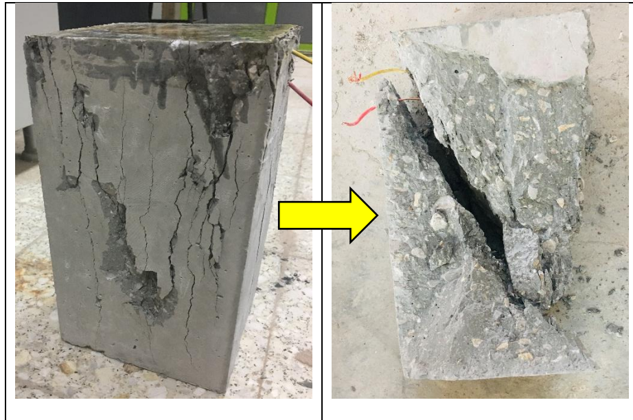
Şekil 147. Beton elemanın hasar şekli.
