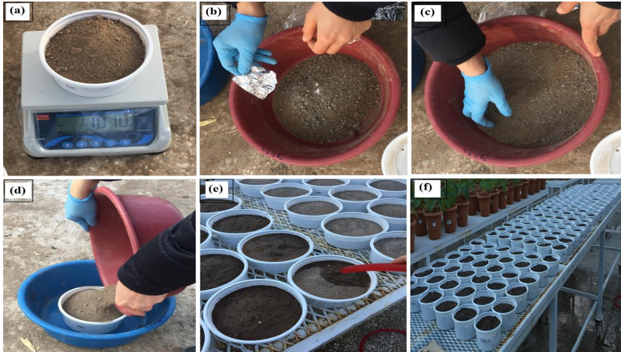
Şekil 6. Ortamın hazırlanmasından inkübasyon aşamasına kadar yapılan işlem aşamalarını gösteren fotoğraflar; (a) toprak:kum (1:1 v:v) oranının hazırlanması, (b) Cd ağır metalinin ortama uygulanması, (c) Cd ağır metali uygulanmış ortamın homojen karışımının sağlanması, (d) Hazırlanan ortamın saksılanması, (e) Ortamın sulanması ve (f) Ortamın serada gruplar halinde inkübasyona bırakılması
