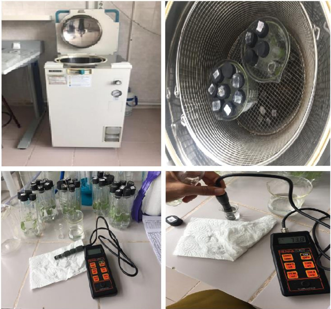
Şekil 15. Doku elektriksel iletkenliklerinin belirlenme aşamalarını gösteren fotoğraflar
