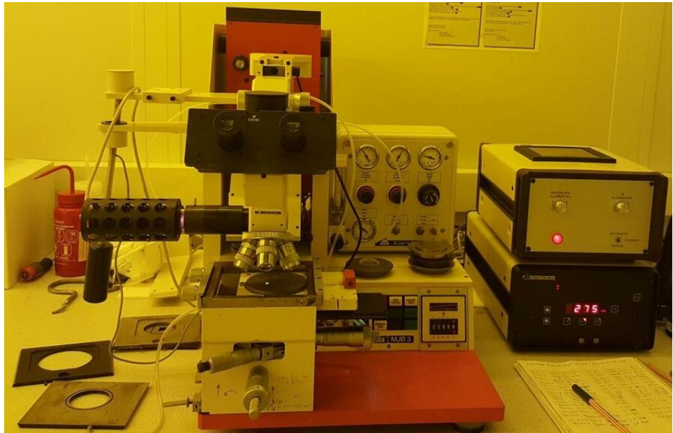
Şekil 3.9. 'Mask Aligner' cihazı (Bilkent Üniversitesi İleri Araştırma Laboratuvarı)
