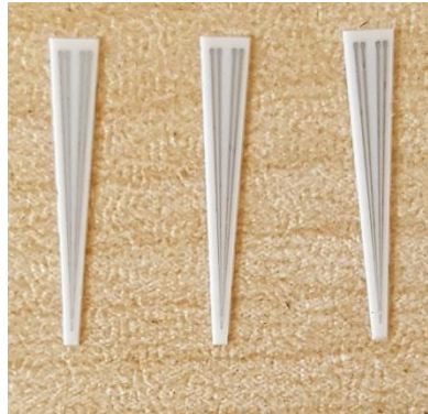
Şekil 3.17. Ucu konik olarak kesildikten sonra mikroelektrotlar
