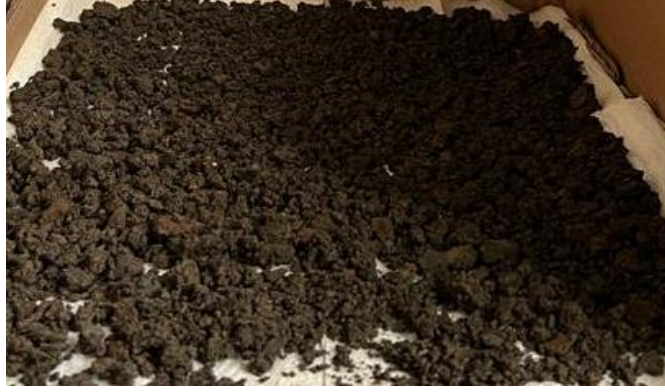
Şekil 7. Havalandırılmış arıtma çamuru
