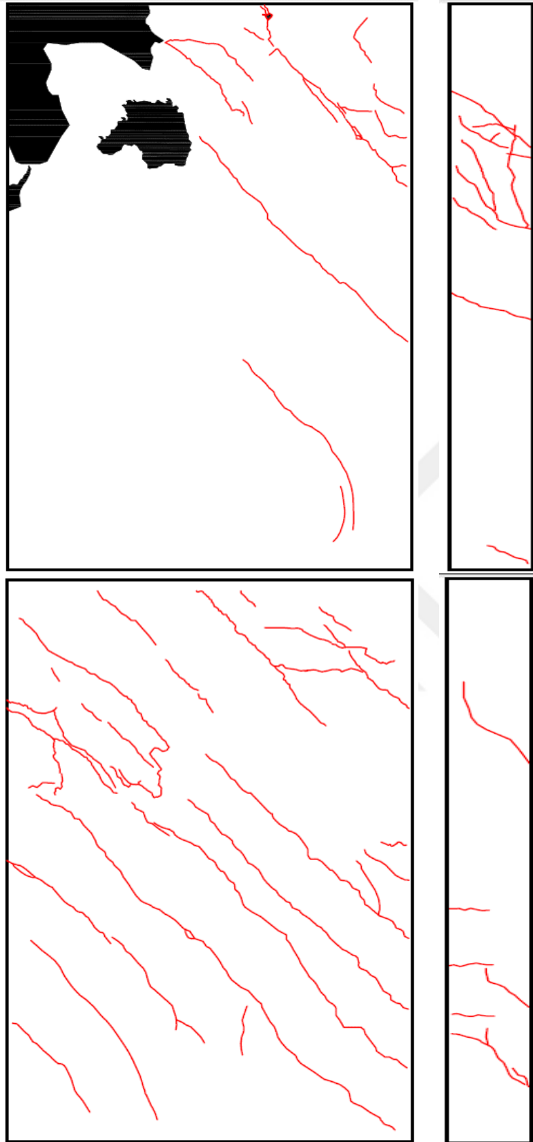
Şekil 88. Göçme moduna ulaşan SW4 numunesinin çatlak dağılımı.
