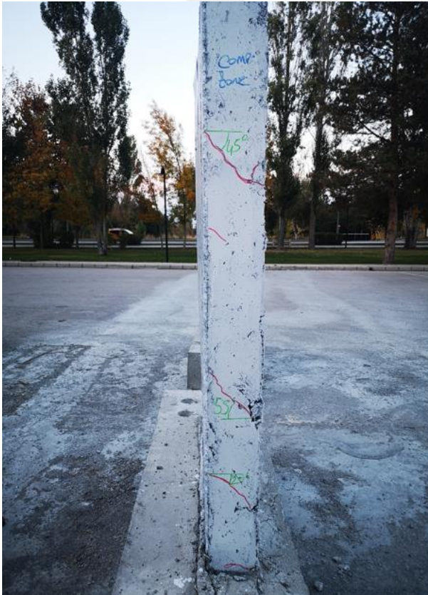
Şekil 111. SW8 numunesinin deneyden sonraki görünümü.
