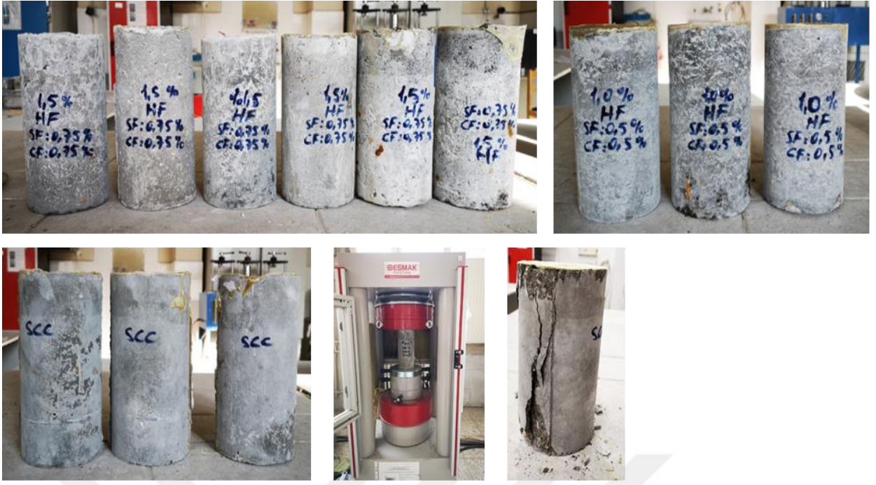
Şekil 55. Basın deneyi sonucunda numunelerin görünümü.
