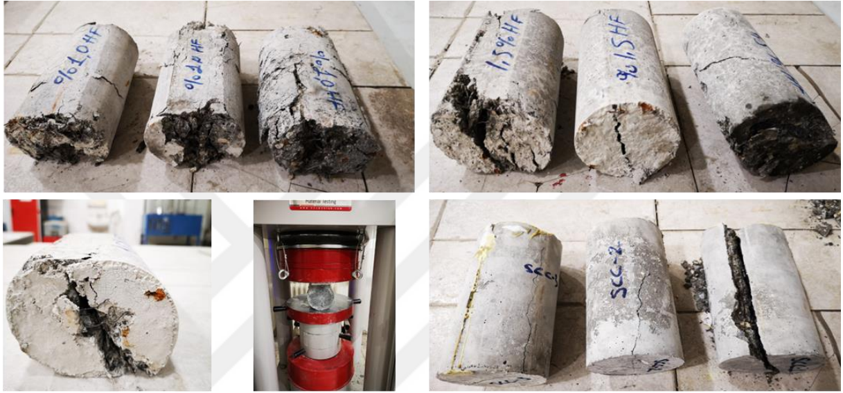
Şekil 57. Yarmada çekme deneyi sonucunda numunelerin görünümü.
