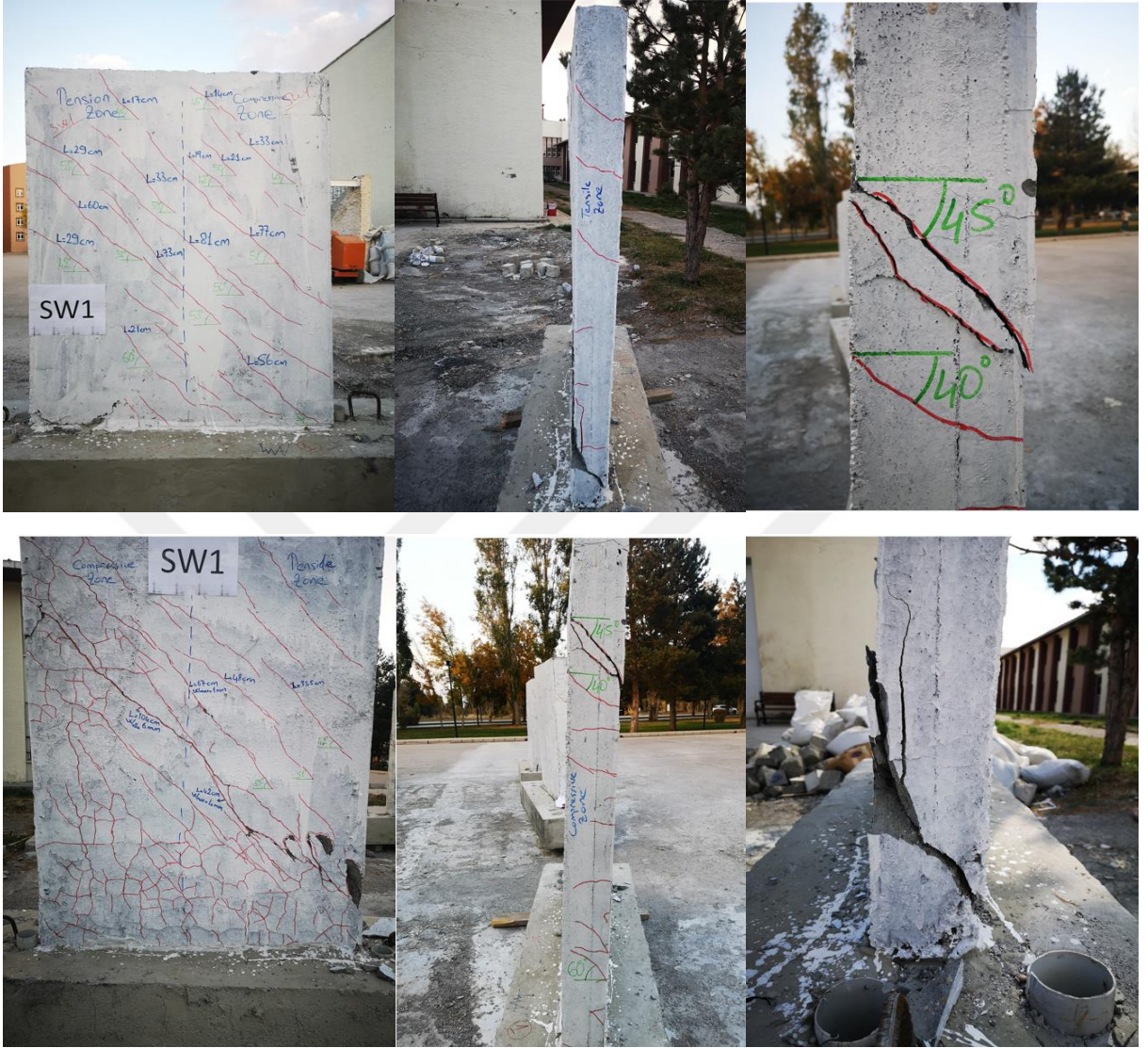
Şekil 65. SW1 numunesinin deneyden sonraki görünümü.
