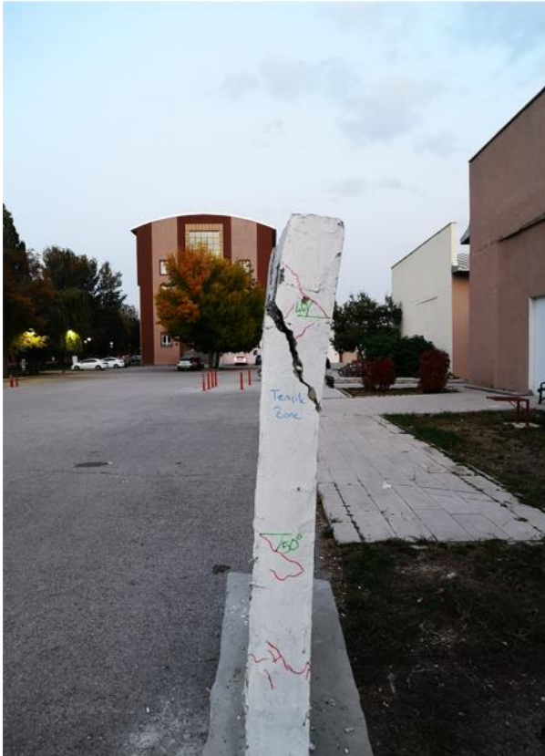
Şekil 81. SW3 numunesinin deneyden sonraki görünümü.
