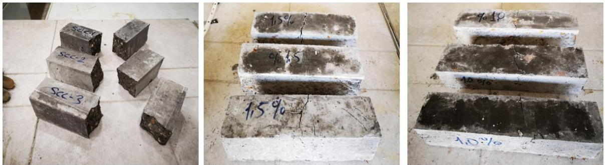
Şekil 56. Eğilme deneyi sonucunda numunelerin görünümü.
