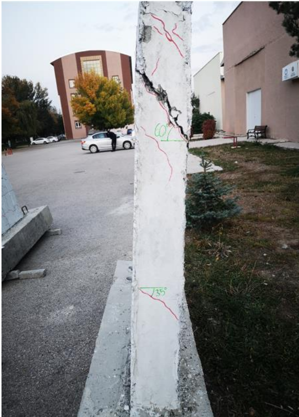
Şekil 117. SW9 numunesinin deneyden sonraki görünümü.
