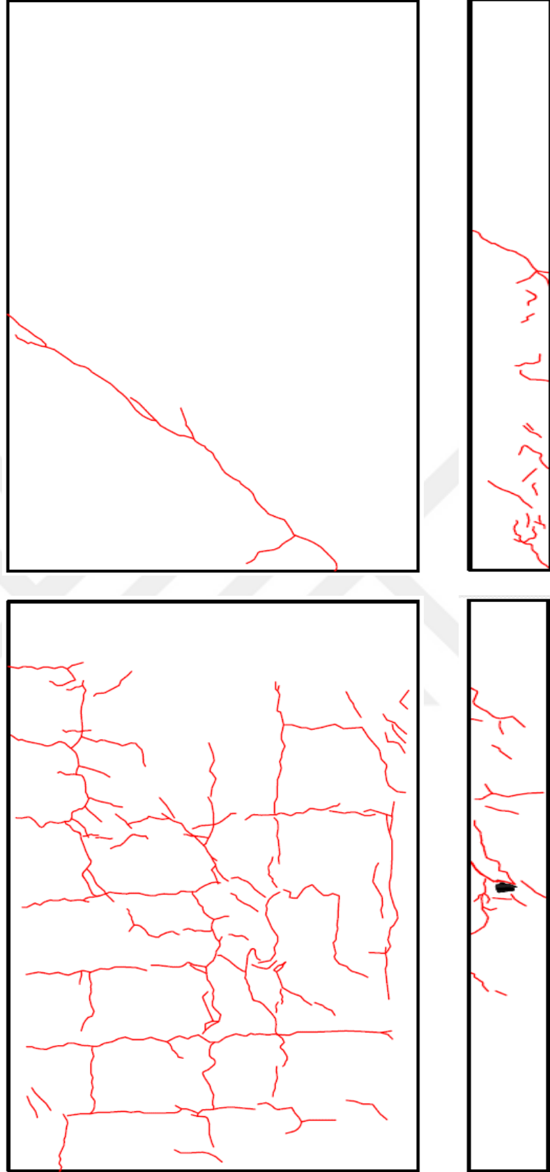
Şekil 100. Göçme moduna ulaşan SW6 numunesinin çatlak dağılımı.
