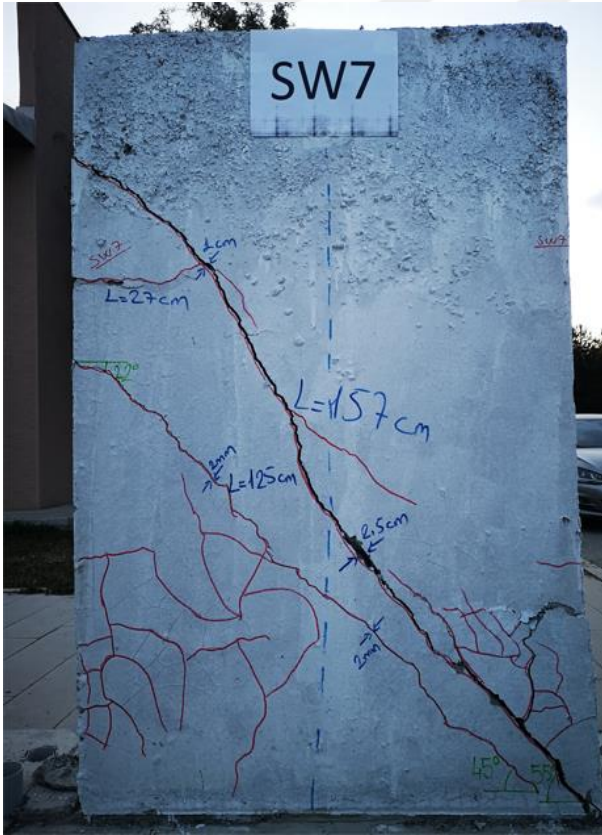
Şekil 105. SW7 numunesinin deneyden sonraki görünümü.
