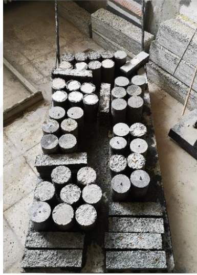
Şekil 52. Perde duvarların beton döküm anında alınan örnek numuneler.
