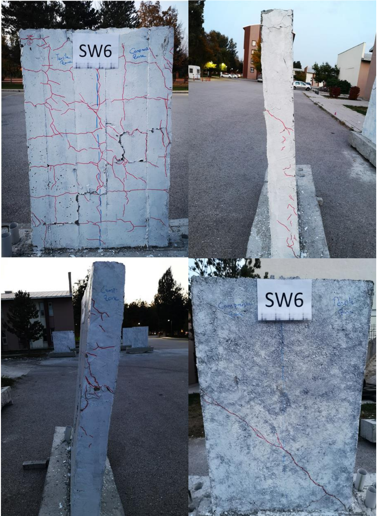
Şekil 99. SW6 numunesinin deneyden sonraki görünümü.
