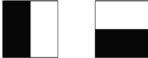
Şekil 3.7. Haar dalga filtrelerinin x ve y yönündeki cevapları (Bay et al. 2009)
