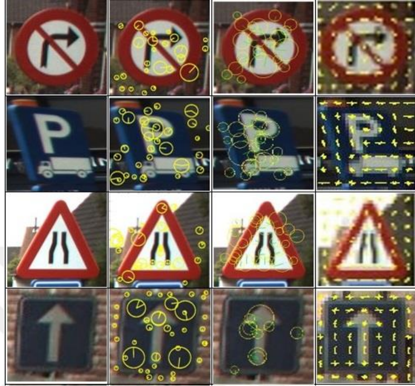
Şekil 4.3. (a) Orijinal Görüntü, (b) SIFT anahtar noktaları, (c) SURF anahtar noktaları, (d) HOG özniteliği (Aydın vd. 2016).
