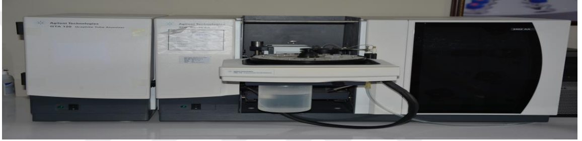
Şekil 3.1. Agilent GTA 120 model 200 Series AA Zeeman Zemin Düzeltmeli ETAAS cihazı
