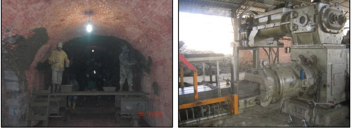
Fotoğraf 3.18. Baykes Tuğla Fabrikası Pişirme Fırını (sol) Tuğla Baskı Makinesi.
