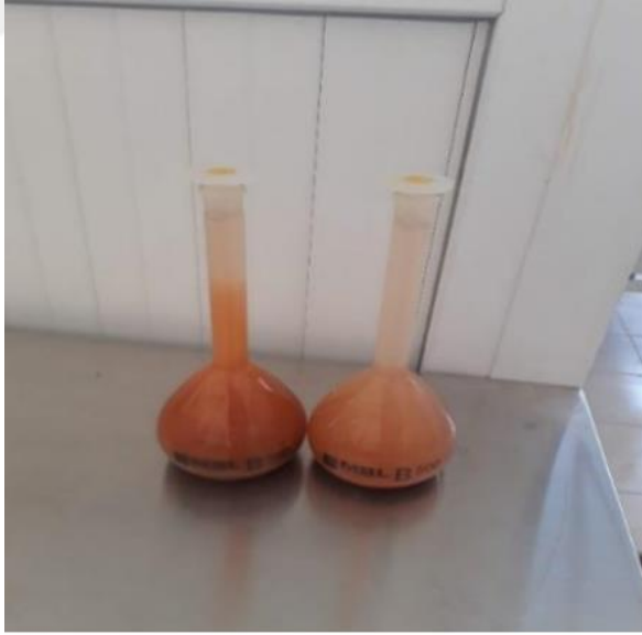
Şekil 18. Özgöl ağırlık deney düzeneđi
