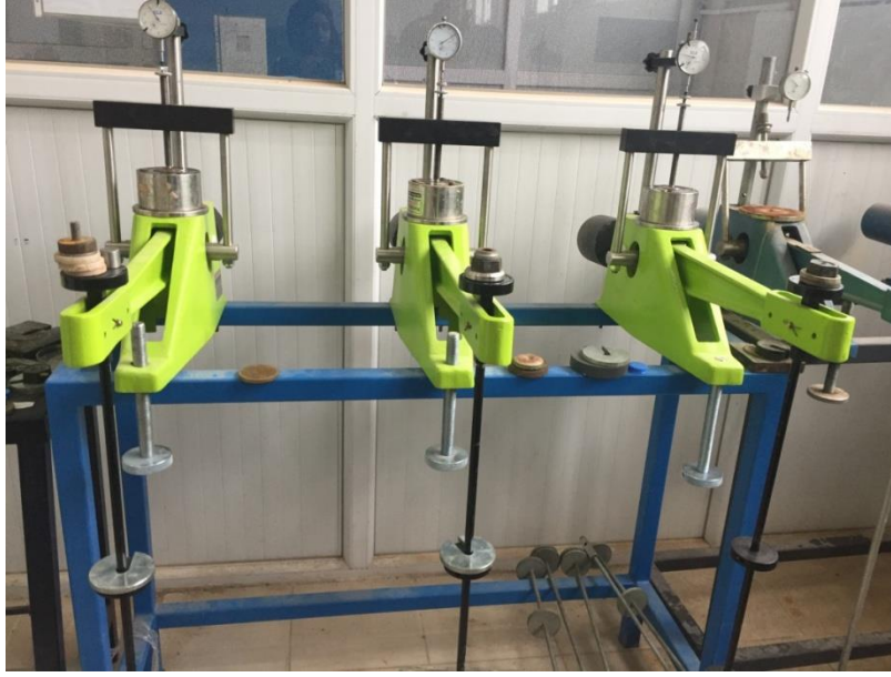
Şekil 21. Ödometre deney düzeneği
