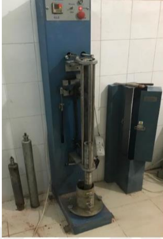
Şekil 20. Otomatik kompaksiyon deney aleti
