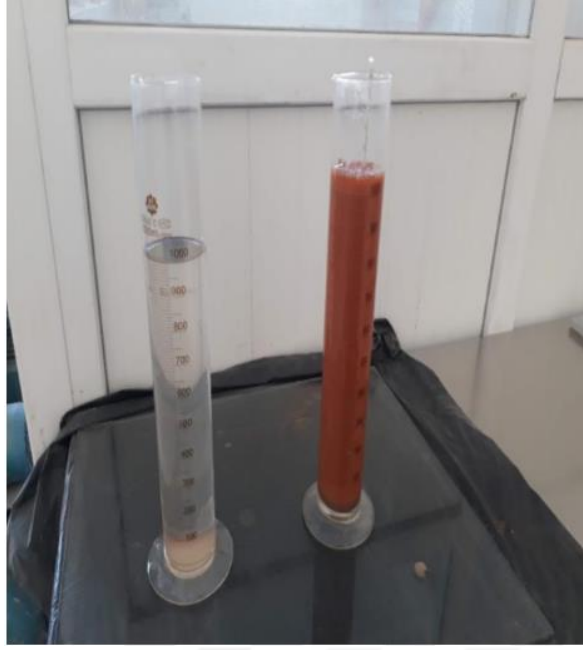
Şekil 17. Hidrometre deney düzeneđi
