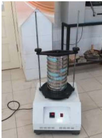
Şekil 5. Çalışmalarımızda kullandığımız Atatürk Üniversitesi Çevre Mühendisliği Bölümünde bulunan Haver & Boecker marka sarsıntılı elek.
