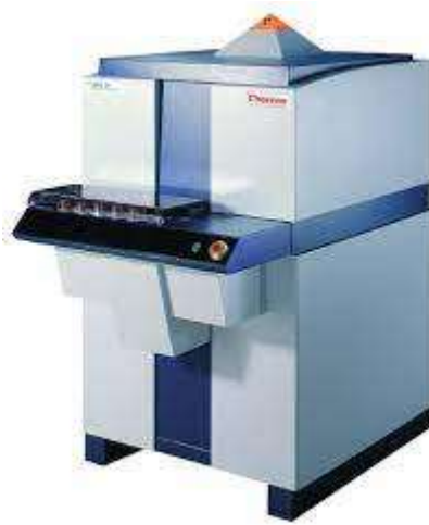
Şekil 11. Çalışmalarımızda kullandığımız Aşkale Çimento’da bulunan ARL 9900 OASIS marka XRF cihazı.
