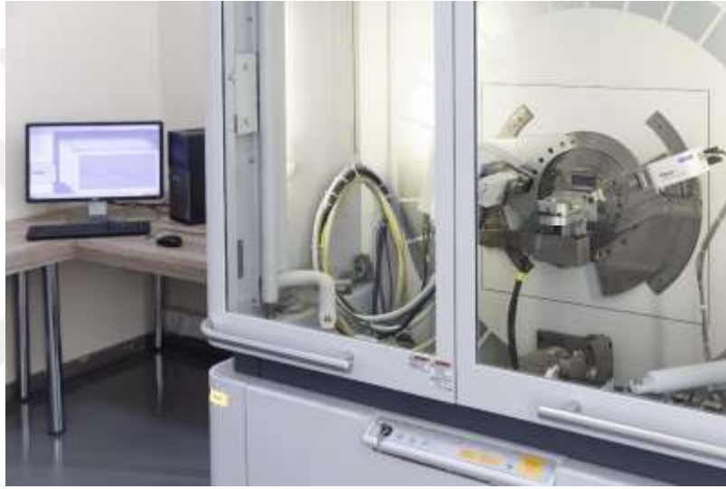
Şekil 7. Çalışmalarımızda kullandığımız Atatürk Üniversitesi DAYTAM’da bulunan PANalytical Empyrean XRD marka X-ışını kırınım cihazı.
