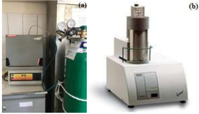
Şekil 9. Çalışmalarımızda kullandığımız Atatürk Üniversitesi Kimya Mühendisliği Bölümünde bulunan a) biyosorbenti 800°C’de AC formuna çevirdiğimiz Carbolite CWF 1200 marka kül fırını b) STA 409 PC-LUXX marka TGA cihazı.
