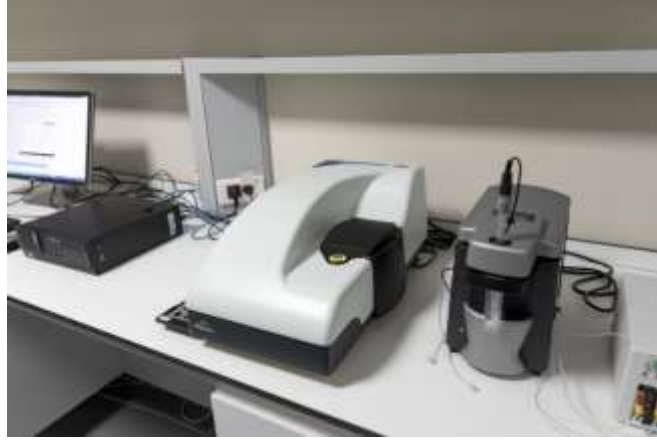
Şekil 6. Çalışmalarımızda kullandığımız Atatürk Üniversitesi DAYTAM’da bulunan Malvern Zetasizer Nano ZSP marka Zeta potansiyeli ölçüm cihazı.
