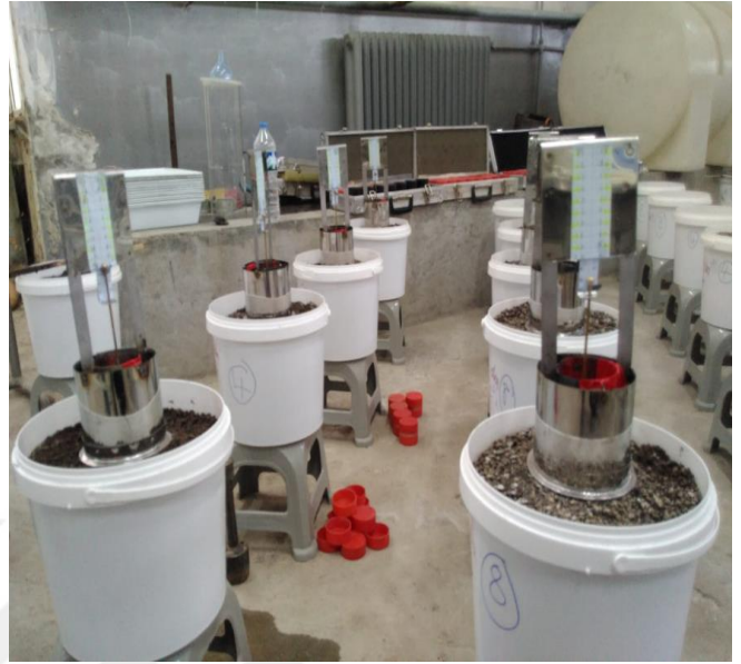
Şekil 3.8. İnfiltrometre düzeneği teknik detayları ve infiltrasyon ölçümleri
