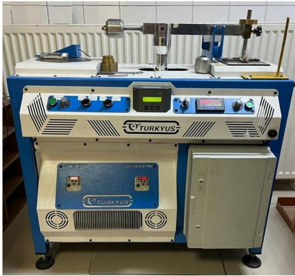
Şekil 32. Aşınma test cihazı ve şematik görünümü (Bozkurt 2021)
