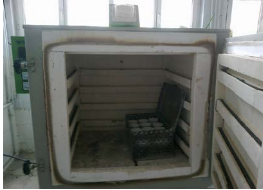
Şekil 3.12. Yüksek sıcaklık fırını
