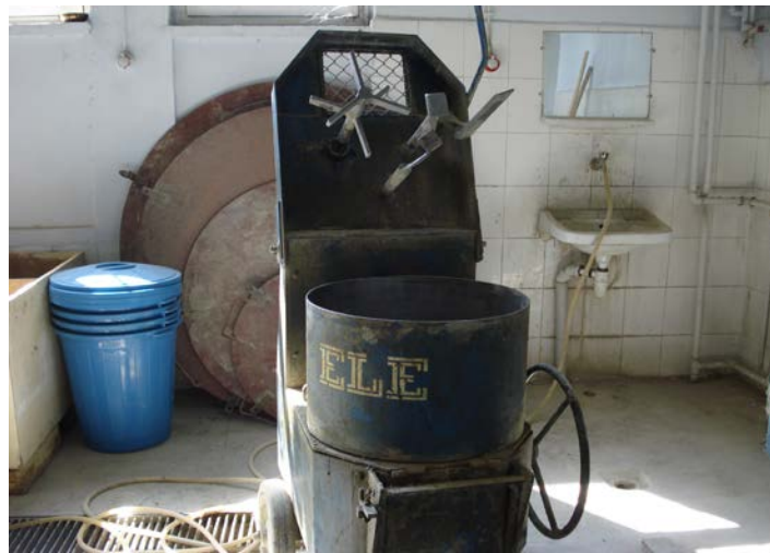
Şekil 3.7. Beton üretiminde kullanılan laboratuvar tipi betonyer
