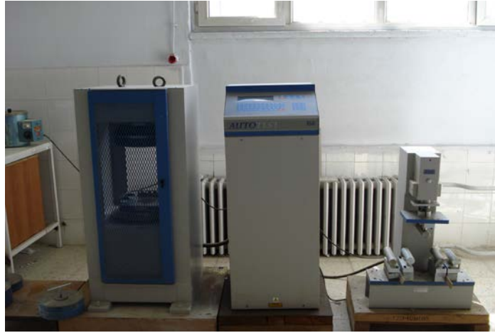
Şekil 3.10. ELE autotest 3000 pres cihazı
