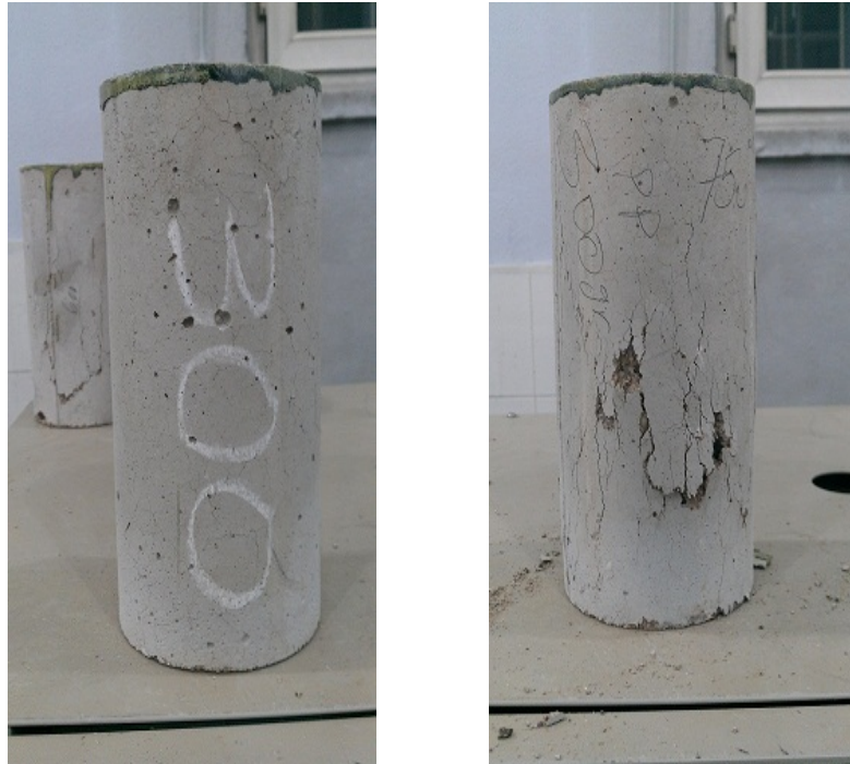
Şekil 4.13. Isıtılmış 300g polipropilen numunelerde 750°C sıcaklık etkisiyle oluşan çatlaklar (yüklemeden önce ve sonra)
