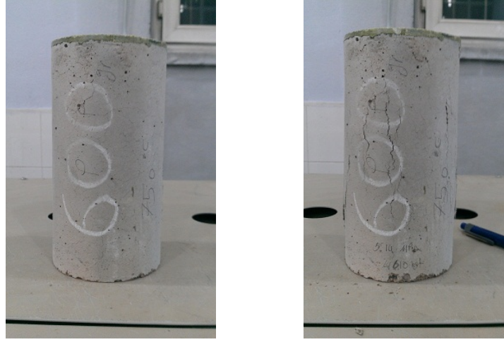
Şekil 4.15. Isıtılmış 600g polipropilen numunelerde 750°C sıcaklık etkisiyle oluşan çatlaklar (yüklemeden önce ve sonra)
