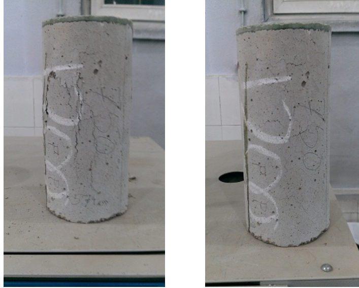
Şekil 4.18. Isıtılmış 1200g polipropilen numunelerde 750°C sıcaklık etkisiyle oluşan çatlaklar (yüklemeden önce ve sonra)
