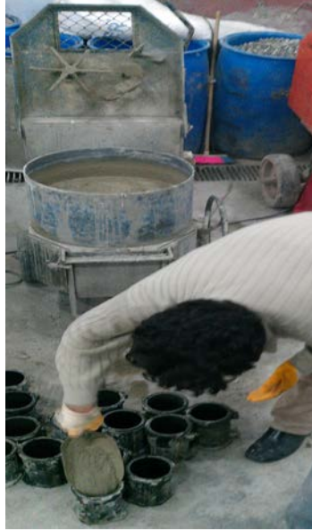
Şekil 3.1. Beton üretimi, deney numunelerinin hazırlanması
