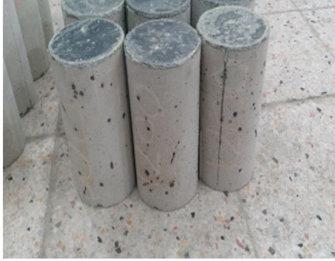
Şekil 4.11. Isıtılmış 1200g polipropilen numunelerde 600°C sıcaklık etkisiyle oluşan çatlaklar ve polipropilen çubuk liflerin erimesi (yüklemeden önce)
