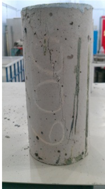
Şekil 4.8. Isıtılmış 600g polipropilen numunelerde 600°C sıcaklık etkisiyle oluşan çatlaklar ve polipropilen çubuk liflerin erimesi (yüklemeden sonra)
