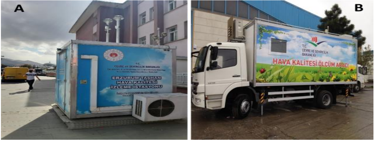
Şekil 13. A) Konvansiyonel hava kalitesi izleme istasyonu B) Mobil hava kalitesi ölçüm aracı
