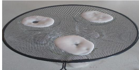
Şekil 3.6. İlk damlama ve tamamen erime süresinin tayini için kullanılan gözenekli tel
