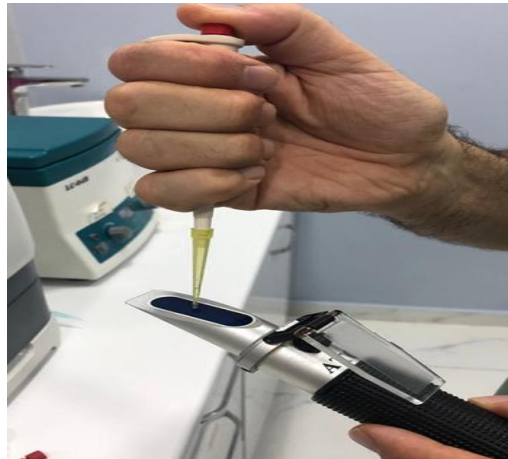
Şekil 3.13. Refraktometreye idrar örneğinin damlatılması
