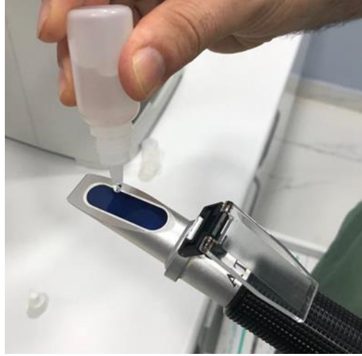
Şekil 3.11. Refraktometrenin distile su ile kalibre edilmesi
