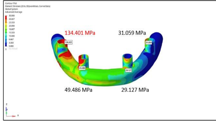
Şekil 4.11. Model 3 protetik altyapı materyalinde vertikal yükleme sonucu oluşan von mises stres dağılımının sonlu elemanlar stres analizi (SESA) görüntüsü
