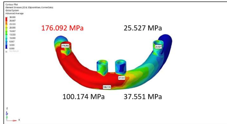
Şekil 4.29. Model 1 oblik yükleme koşulu altında metal altyapı üzerindeki von Mises stres dağılımının sonlu elemanlar stres analizi (SESA) görüntüsü
