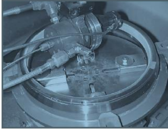
Şekil 2.4. ÇJS tekniğiyle kaplanmış bir roket motoru manifoldu
