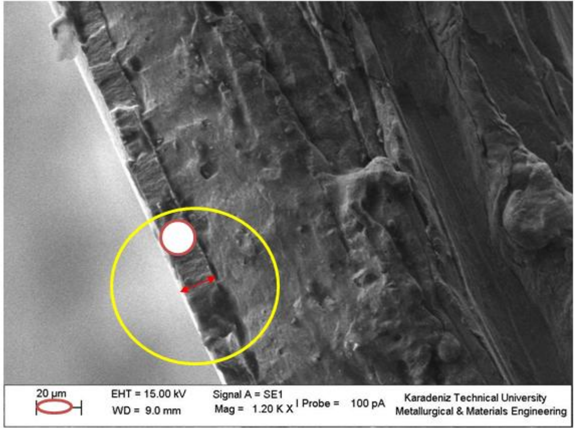
Şekil 4.4. (H/d)=1 'de V_j=3,47(\text{m/s}) 'de Cu alt malzeme üzerine yapılan kaplamanın SEM görüntüsü (12,4 \mu\text{m} )
