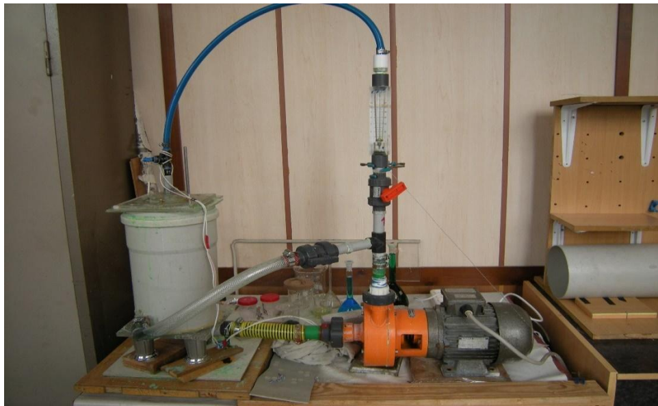
Şekil 3.2. Deney düzeneği (daldırılmamış çarpan jet elektrokimyasal kaplama sistemi)
