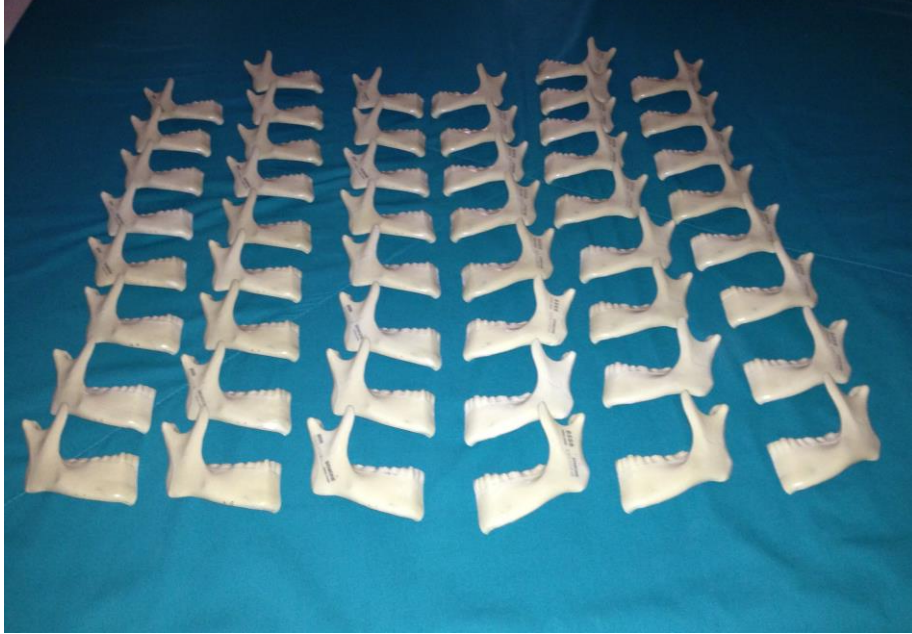
Şekil 3.1. Deneylerde kullanılan poliüretan hemimandibula replikalar
