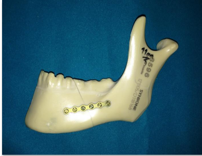
Şekil 3.13. 6 delikli konvansiyonel plak ve 11 mm self tapping vidalar (B kırık hattı)
