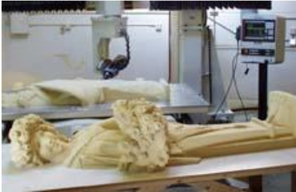
Resim 3.5. Bir modelin, işe özel yapılmış elle kontrol edilebilen laser tarayıcı ile taranarak bilgisayar ortamına aktarılmasının ardından, bilgisayar kontrollü bir makine (CNC) tarafından kopyanın üretilmesi 114
