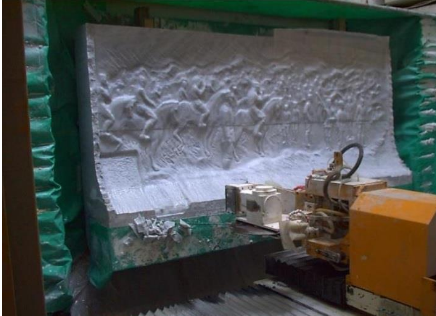
Resim 3.7. Rölyef tasarımının CNC makine tezgahında kopyalanması 116
