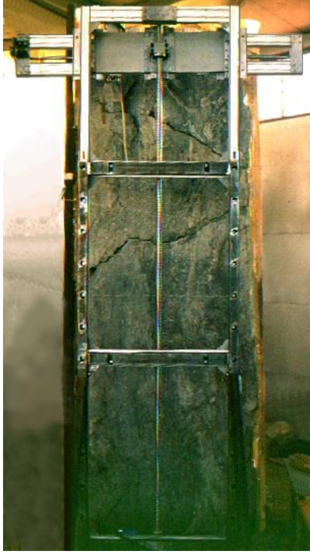
Resim 3.1 Laser tarayıcının Bilge Kağan yazıtı üzerinde kopyalama işlemini uygulaması.
