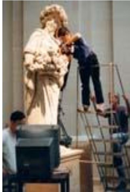
Resim 3.3. Bir modelin, işe özel yapılmış elle kontrol edilebilen laser tarayıcı ile taranarak bilgisayar ortamına aktarılmasının ardından, bilgisayar kontrollü bir makine (CNC) tarafından kopyanın üretilmesi 112
