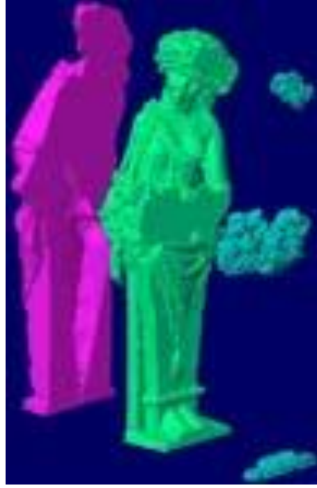
Resim 3.4. Bir modelin, işe özel yapılmış elle kontrol edilebilen laser tarayıcı ile taranarak bilgisayar ortamına aktarılmasının ardından, bilgisayar kontrollü bir makine (CNC) tarafından kopyanın üretilmesi 113
