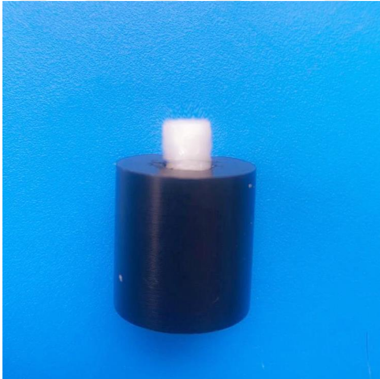
Şekil 3.16. Kompozit dolgu materyali ile yapılan örnek kor yapısı
