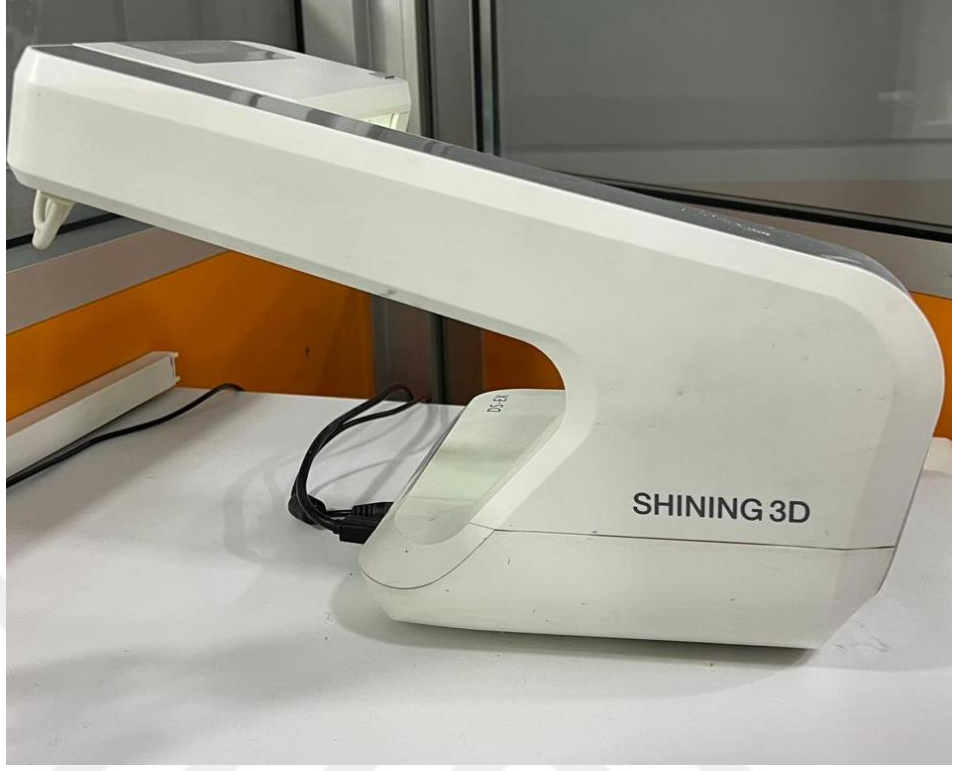
Şekil 3.7. Dijital, laboratuvar tipi ölçü tarayıcı
