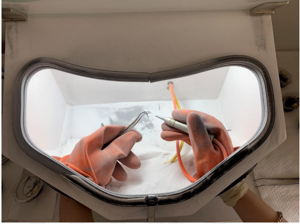
Şekil 3.15. Metal post örneklerin yüzeyinin kumlanmasına ait görüntü
