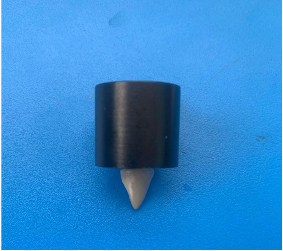
Şekil 3.21. Hazırlanan zirkonyum alt yapı kuronların proksimal yüzden görüntüsü
