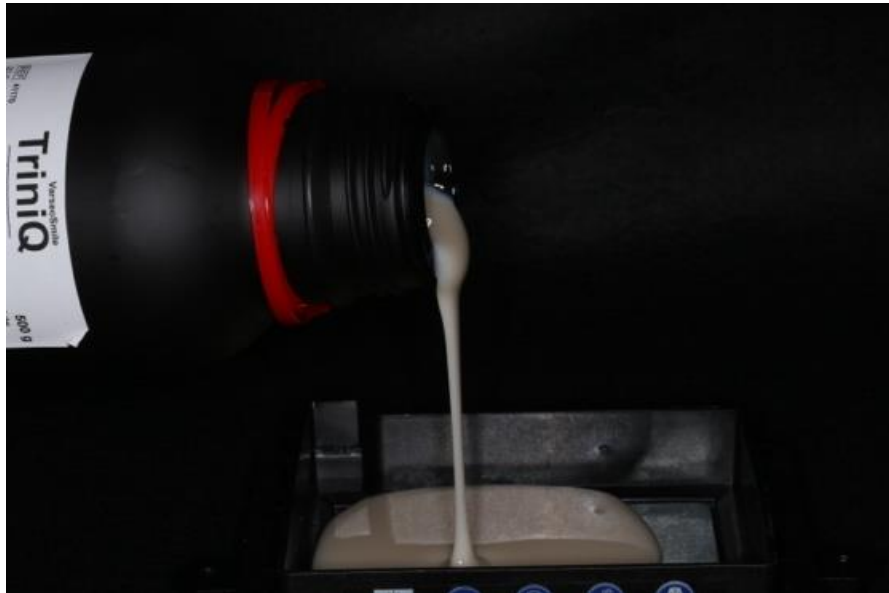
Şekil 3.8. Reçinenin Üretim Tankına Aktarılması
