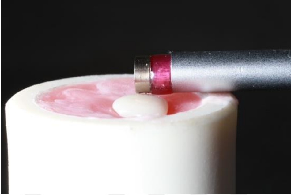
Şekil 3.20. Yüzey Pürüzlülük Ölçümü
