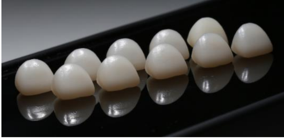
Şekil 3.13. 3 Boyutlu Yazıcı ile Üretilen Kuronlar
