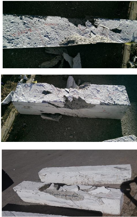
Şekil 4.28. NC4E10-2 numunesinde meydana gelen burulma çatlakları
