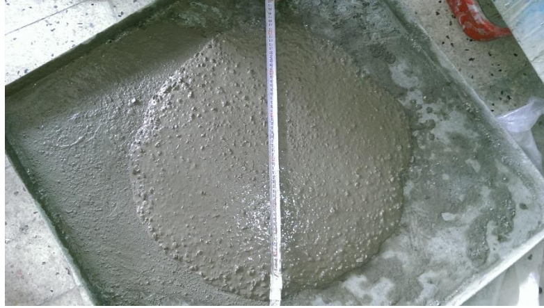
Şekil 4.31. C20 beton sınıfı yayılma deneyi
