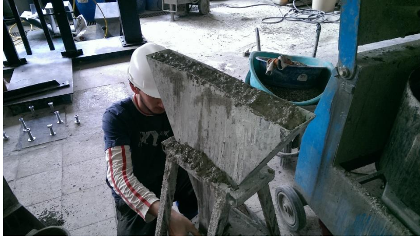
Şekil 4.33. C20 beton sınıfı V hunisi deneyi
