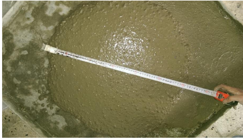
Şekil 4.32. C40 beton sınıfı yayılma deneyi
