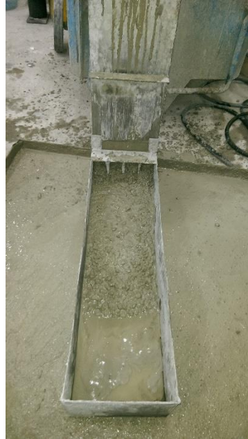
Şekil 4.36. C40 beton sınıfı L kutusu deneyi
