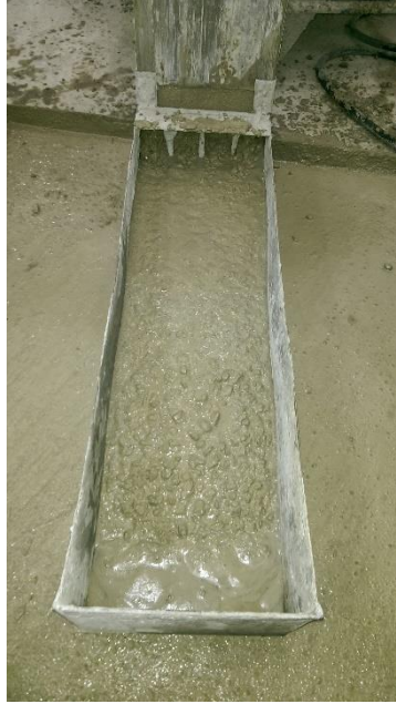
Şekil 4.35. C20 beton sınıfı L kutusu deneyi
