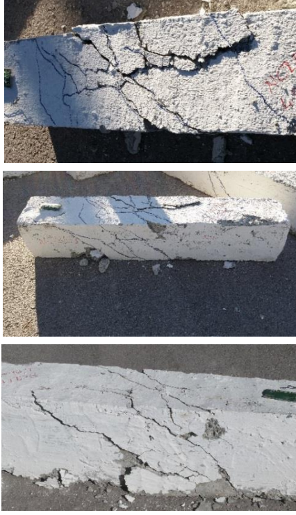
Şekil 4.21. NC2E10-1 numunesinde meydana gelen burulma çatlakları
