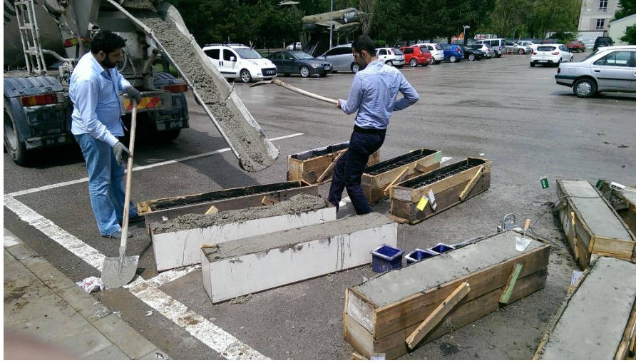
Şekil 4.2. Normal beton deneyleri için beton dökümü
