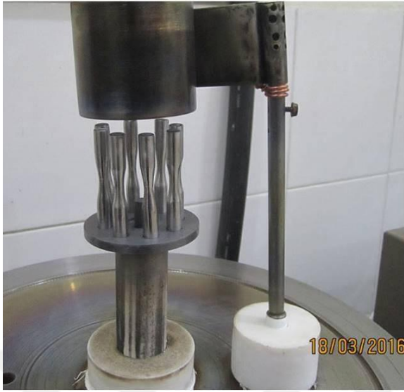
Şekil 3.8. Numune tutucusu ve cihazda yerleşimi
