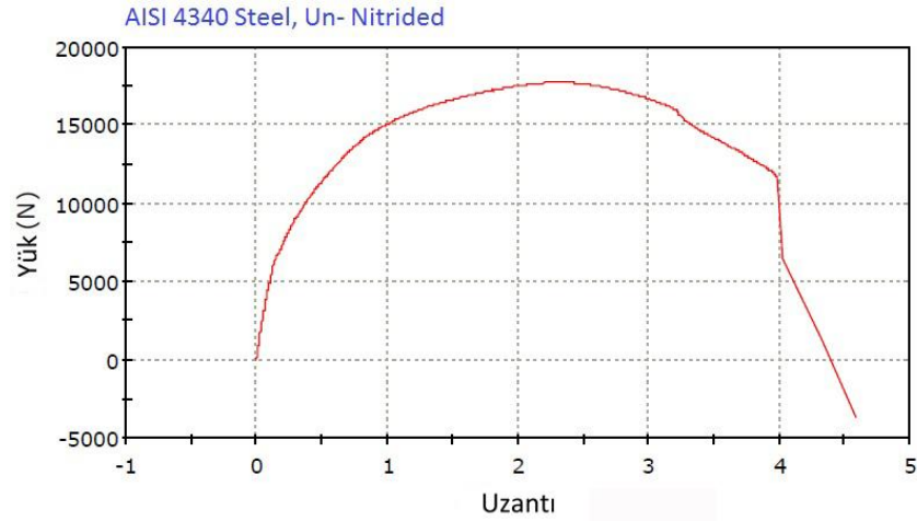
Şekil 4.12. Normaliz edilmiş numenin çekme dayanımı testi
