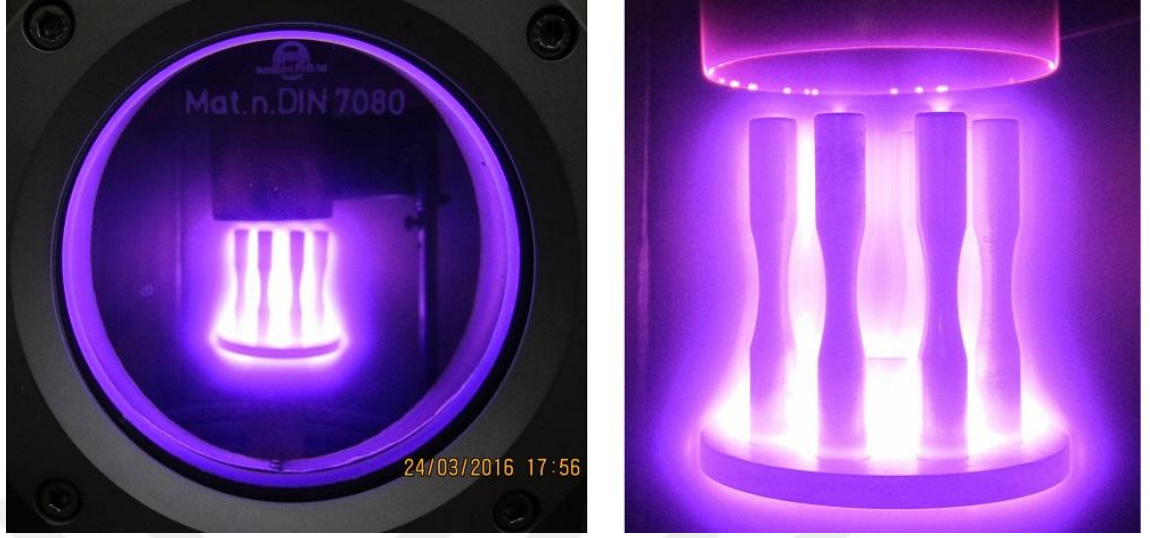
Şekil 3.6. Yorulma numunelerinin nitrülenmesi esnasında alınan örnek görüntüler
