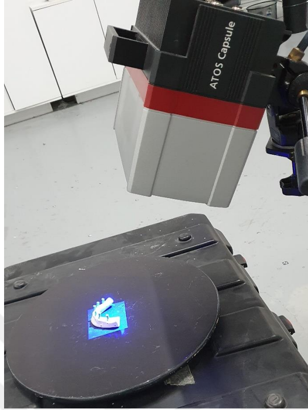
Şekil 3.5. Referans model taraması için Atos Capsule ile yapılan tarama
