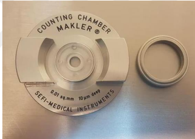
Şekil 3.3. Semen örneğinin incelendiği Makler Chamber
