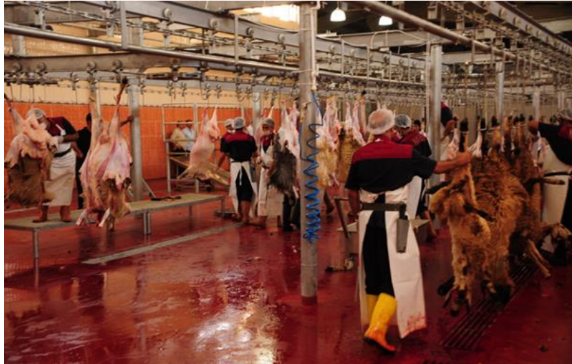
Şekil 2.2. Küçük baş hayvanların karkasından deri ayırma işlemi
