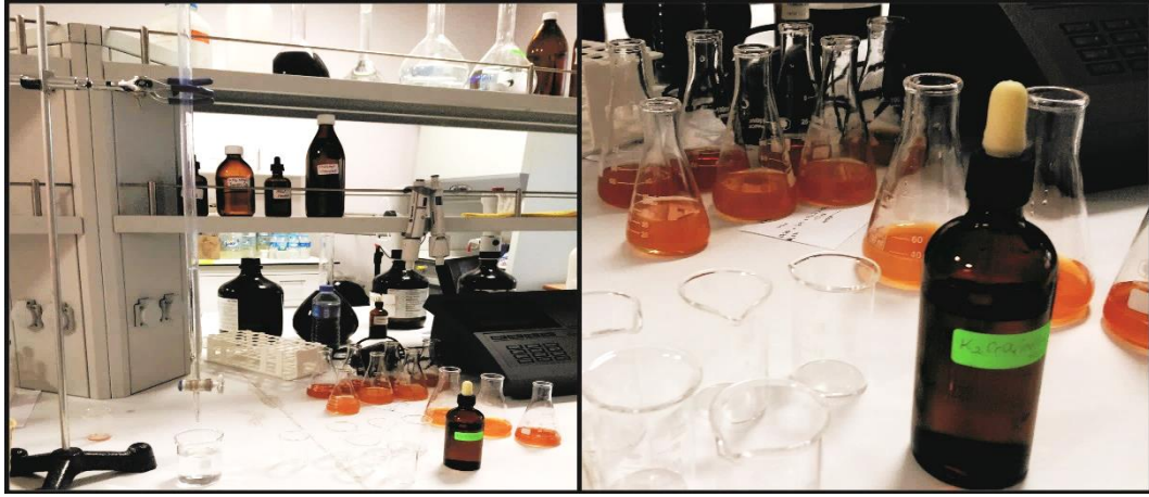
Şekil 3.4. Mohr metodu ile \text{Cl}^- tayini düzeneği (sol), renk dönüşümü (sağ)
