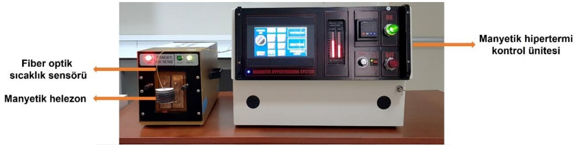
Şekil 7. Manyetik hipertermi cihazı (MSI Automation Hyper-5)
